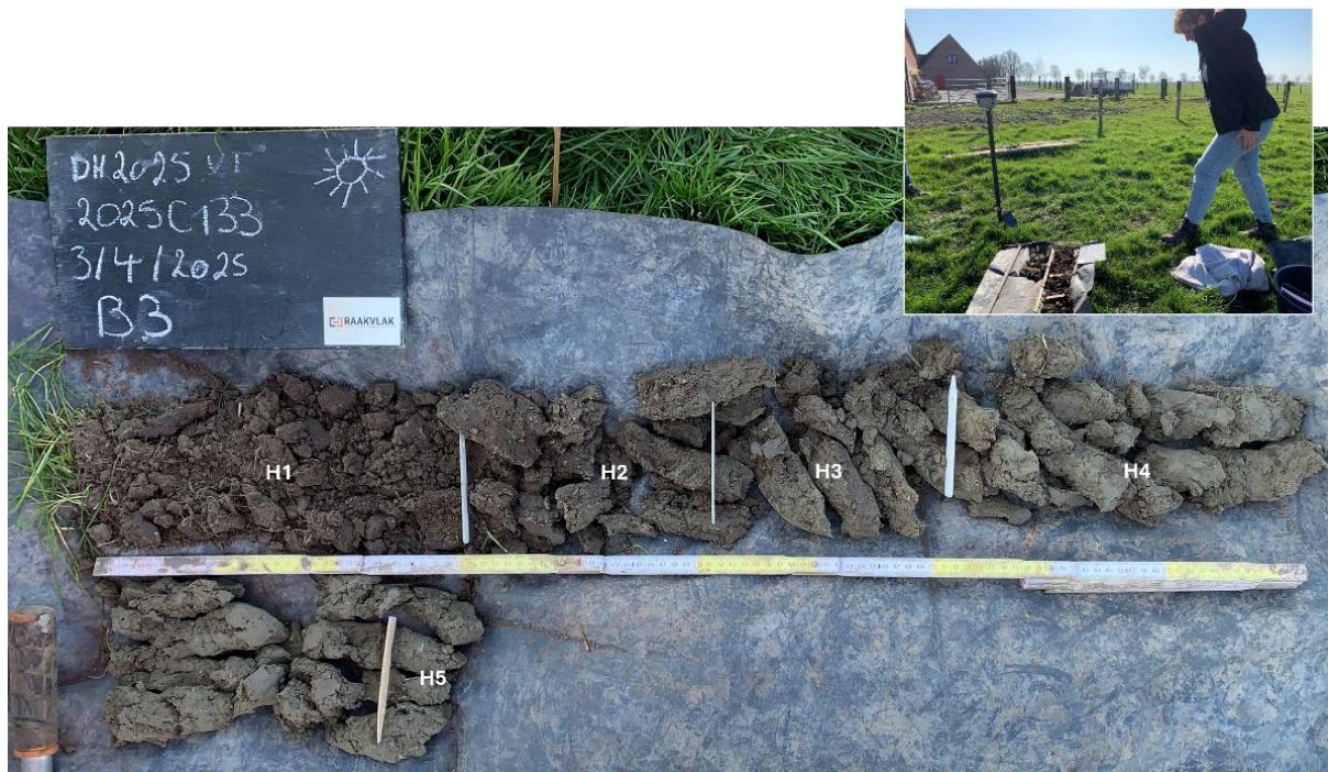
Figuur 31: Boring 3 met aanduiding van de horizonten (Raakvlak)
