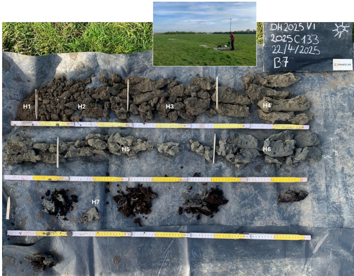
Figuur 34: Boring 7 met aanduiding van de horizonten (Raakvlak)
