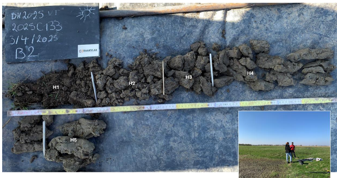
Figuur 32: Boring 2 met aanduiding van de horizonten (Raakvlak)
