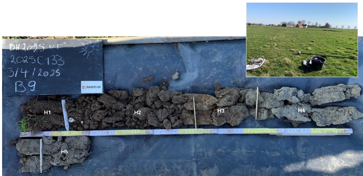
Figuur 39: Boring 9 met aanduiding van de horizonten (Raakvlak)
