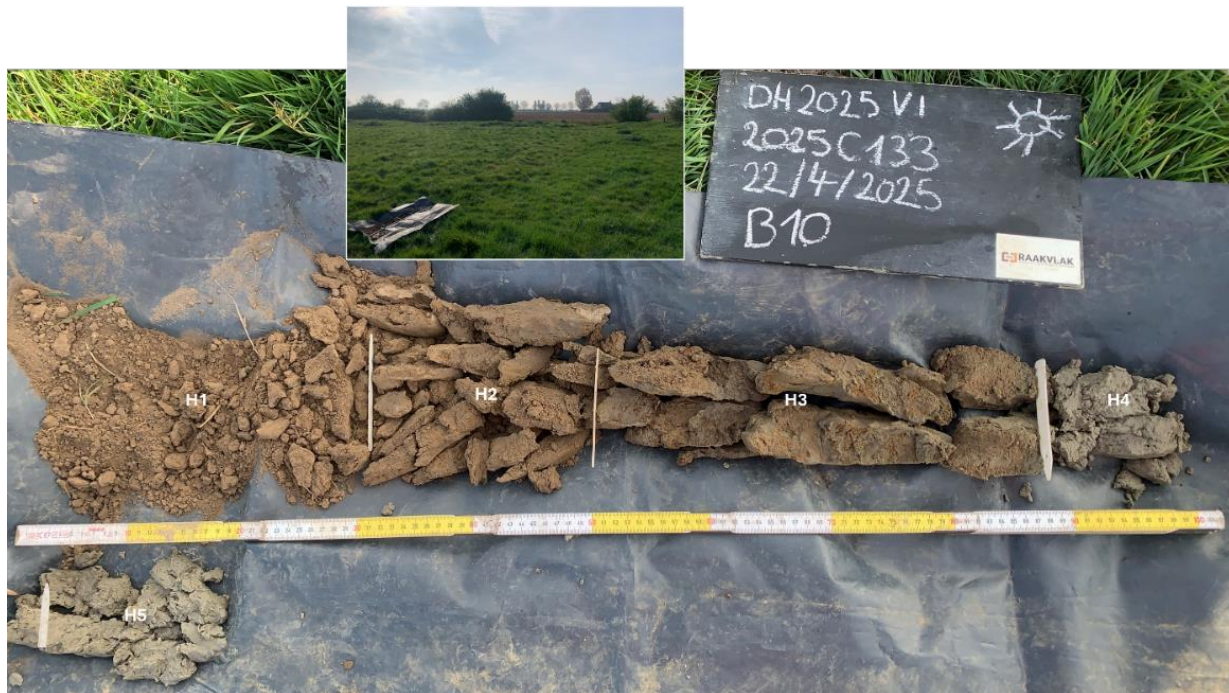
Figuur 29: Boring 10 met aanduiding van de horizonten (Raakvlak)
