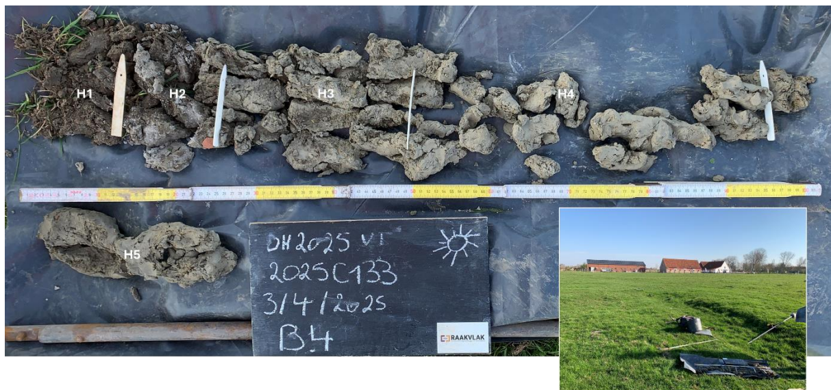
Figuur 38: Boring 4 met aanduiding van de horizonten (Raakvlak)
