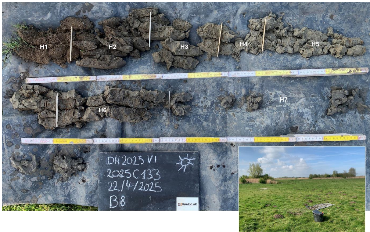
Figuur 36: Boring 8 met aanduiding van de horizonten (Raakvlak)
