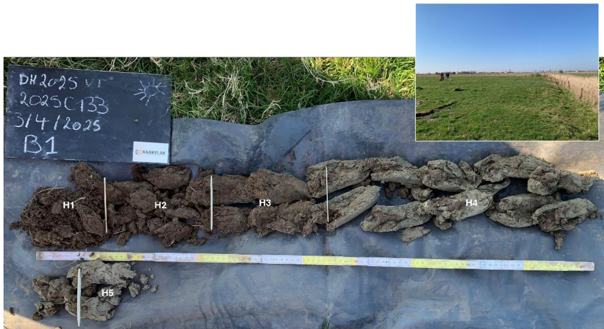
Figuur 30: Boring 1 met aanduiding van de horizonten (Raakvlak)
