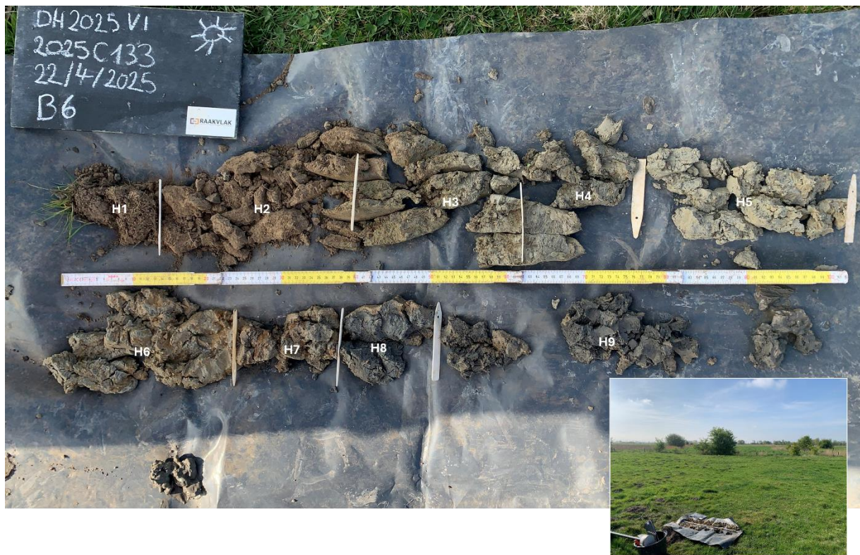
Figuur 29: Boring 6 met aanduiding van de horizonten (Raakvlak)
