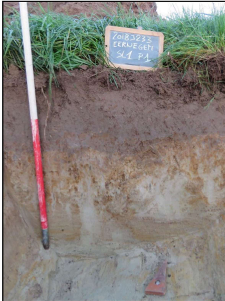
Fig. 1.41: Profielpit met een A/C-bodemprofiel (© Acke et al. 2018).
