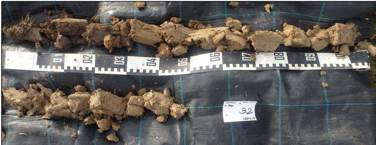
Figuur 48: Boring 2 van 0 (linksboven) tot 150 cm (rechtsonder) beneden maaiveld.
