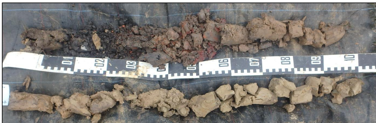
Figuur 46: Boring 6 van 0 (linksboven) tot 200 cm (rechtsonder) beneden maaiveld.
