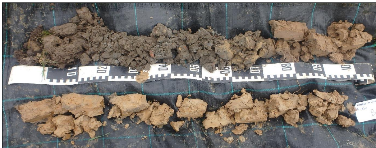
Figuur 47: Boring 1 van 0 (linksboven) tot 200 cm (rechtsonder) beneden maaiveld.
