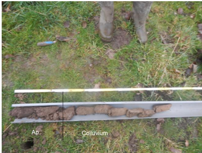
Afbeelding 21: Foto van boring 4 met aanduiding van de verschillende bodemborizonten.
