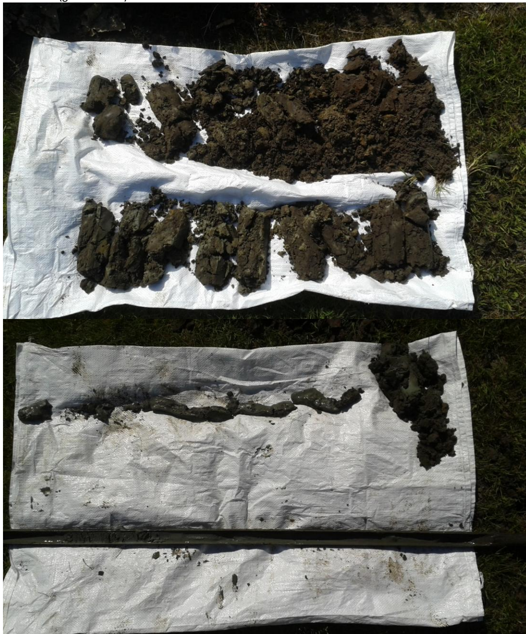
Afb. 24. Het opgeboorde materiaal uit boring 9 in vier rijen, van boven naar onder en van rechts naar links: 0-1 m; 1-2 m; 2-3 m en 3-4 m –mv.
