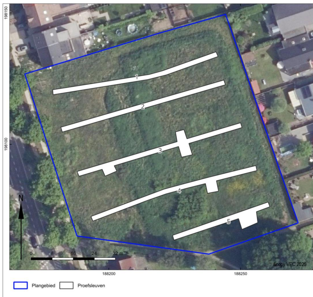
Figuur 1010: Overzicht van de aangelegde proefsleuven.
