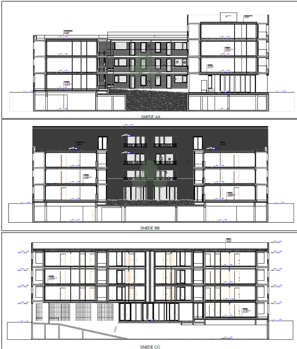
Figuur 11: Doorsnede gebouw zone centraal. 15
