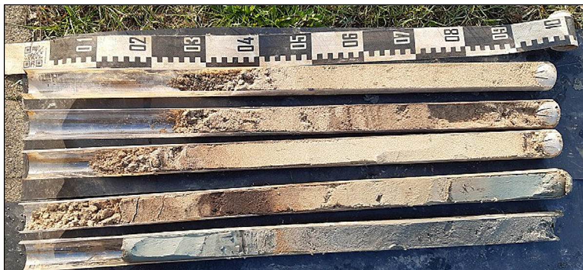
Figuur 15 : Boring 3; van 0 (linksboven) naar 500 cm (rechtsonder) beneden het maaiveld.
