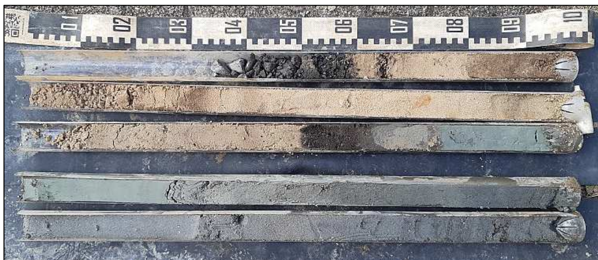
Figuur 13: Boring 1; van 0 (linksboven) naar 500 cm (rechtsonder) beneden het maaiveld.
