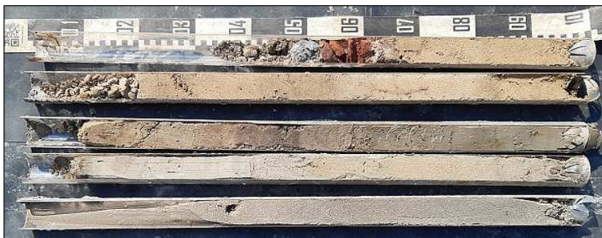
Figuur 20: Boring 8; van 0 (linksboven) naar 500 cm (rechtsonder) beneden het maaiveld.
