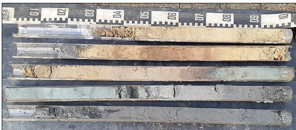
Figuur 17: Boring 5; van 0 (linksboven) naar 500 cm (rechtsonder) beneden het maaiveld.
