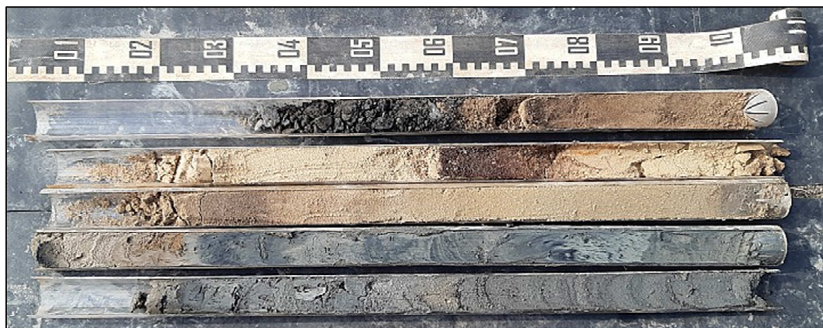
Figuur 14: Boring 2; van 0 (linksboven) naar 500 cm (rechtsonder) beneden het maaiveld.
