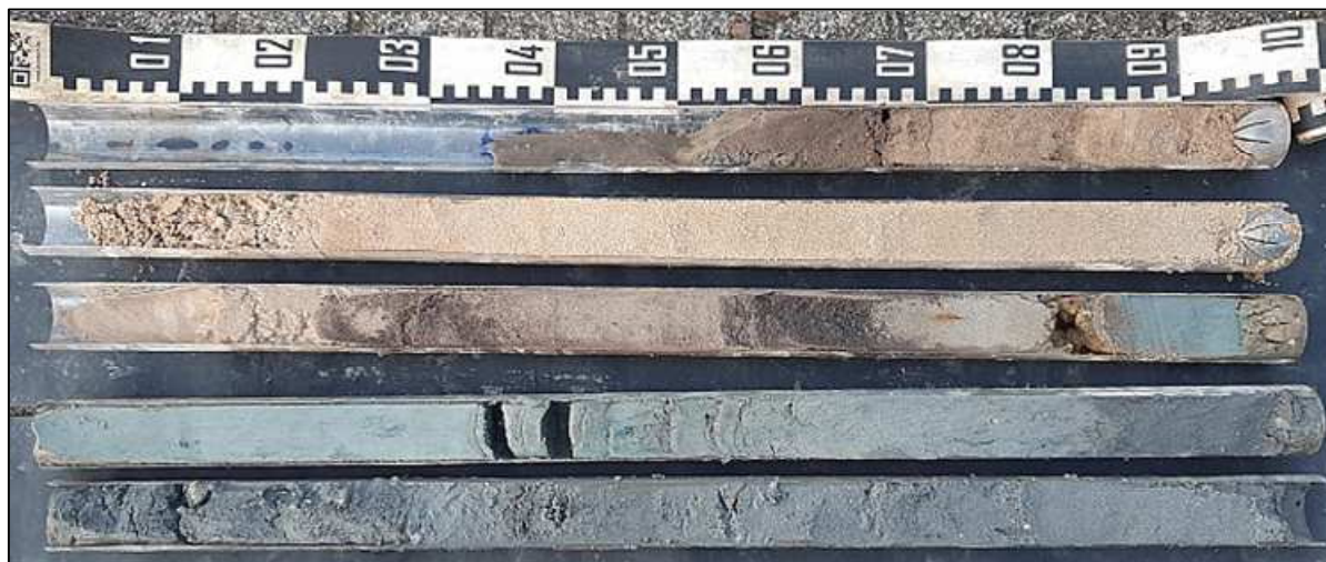
Figuur 16: Boring 4; van 0 (linksboven) naar 500 cm (rechtsonder) beneden het maaiveld.
