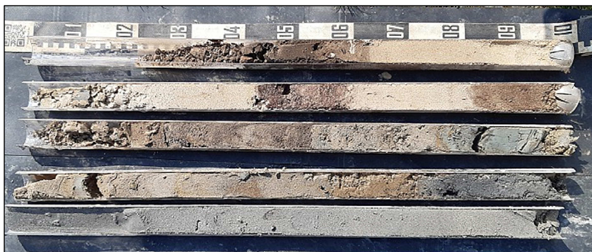
Figuur 18: Boring 6; van 0 (linksboven) naar 500 cm (rechtsonder) beneden het maaiveld.
