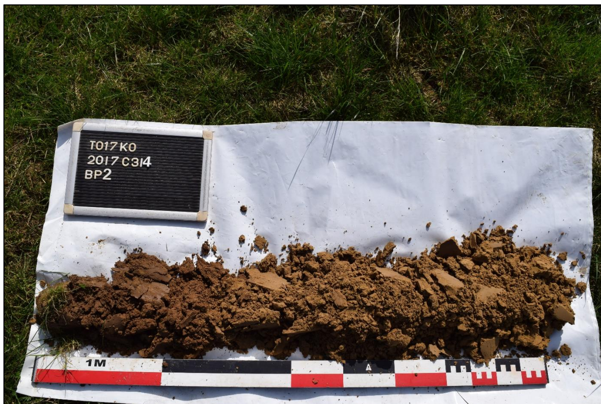
Afb. 12: Fotografische opname van boorpunt BP2 met de volgende lagen: Ap – C (Bron: Aron bvba, 23/03/2017, 2017D232).
