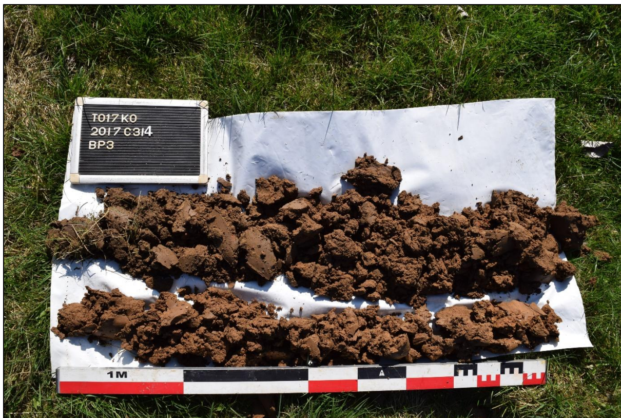
Afb. 13: Fotografische opname van boorpunt BP3 met de volgende lagen: Ap – ophoging/all – C (Bron: Aron bvba, 23/03/2017, 2017D232).
