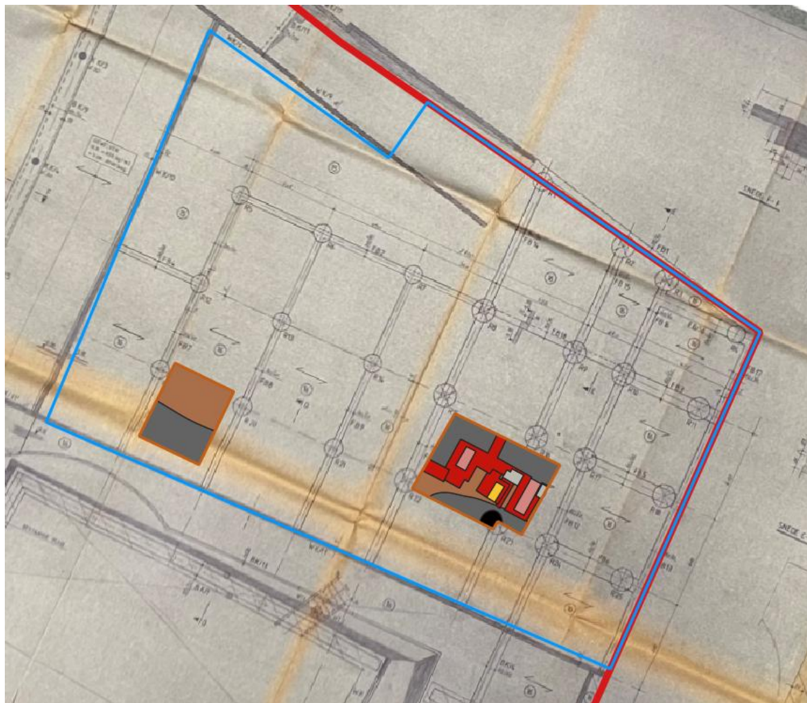
Figuur 25: De proefputten geplot op het funderingsplan van de gebouwen uit de jaren '90 van vorige eeuw. Daarop aangegeven de ronde funderingspalen en de bestaande kelderwand. 15
