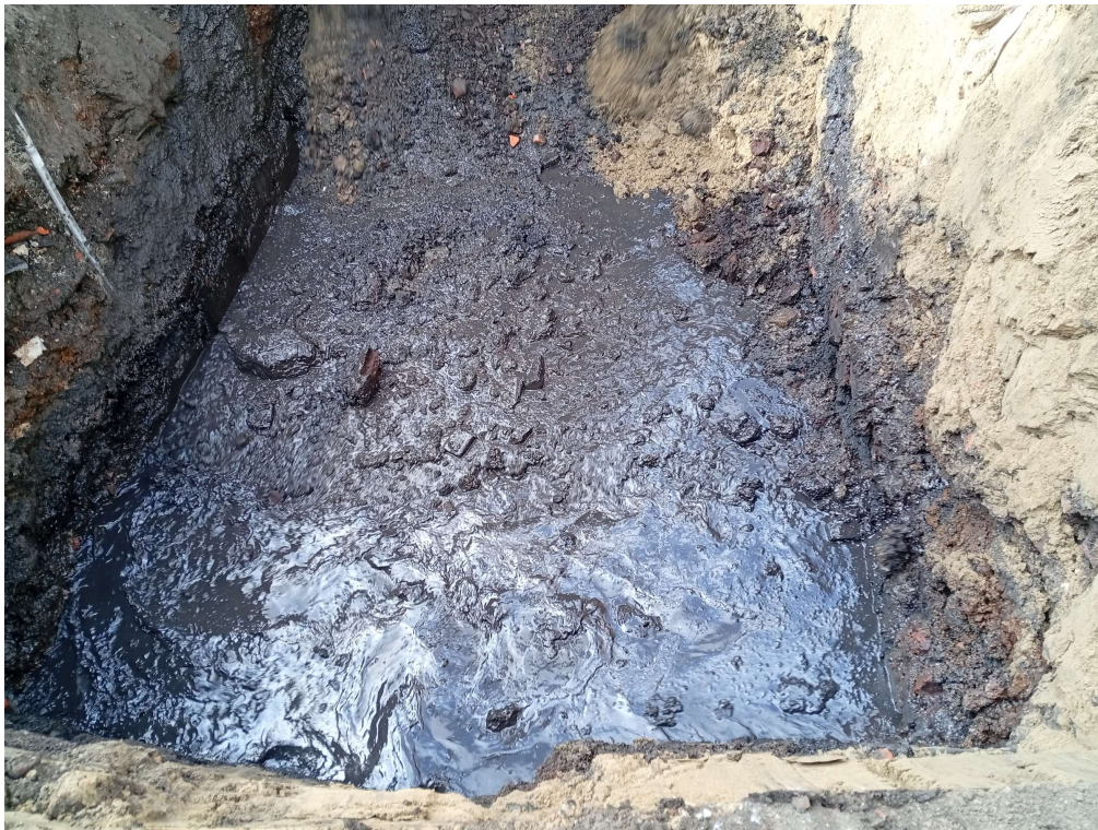
Fig. 2.10: Zicht op de wateroverlast in Proefput 2 (WP2).
