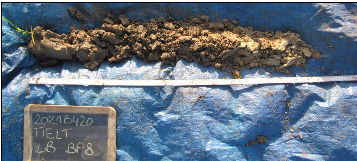
Figuur 34 Boorprofiel 8 met A(p) – C bodemprofiel.
