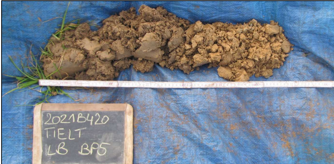
Figuur 32 Boorprofiel 5 met A(p) – C bodemprofiel.
