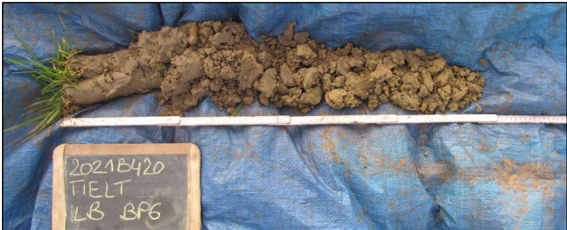
Figuur 33 Boorprofiel 6 met A(p) – C bodemprofiel.
