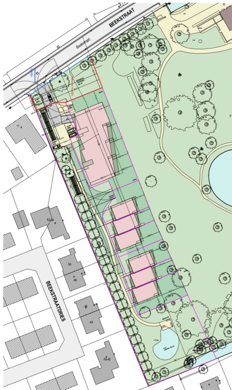
Figuur 5: Inplantingsplan verkaveling: alleen in het westelijke deel zijn werken in kader van de verkaveling gepland. 9
