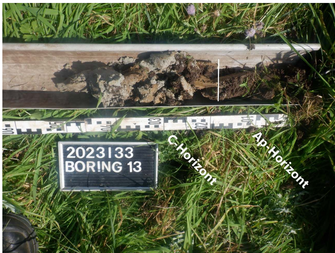
Afbeelding 8.3: Boring 13 met aanduiding van de verschillende bodemlagen.
