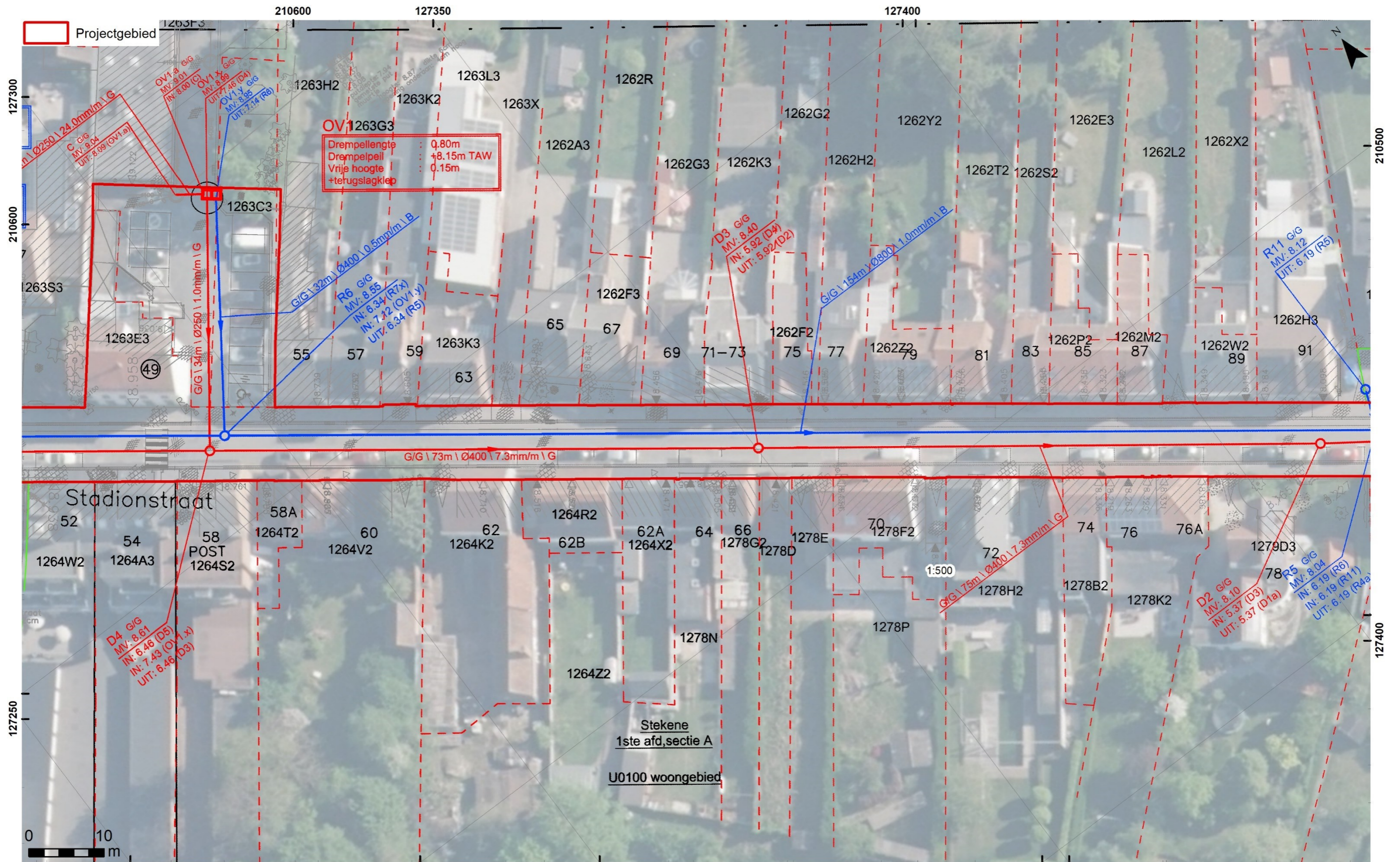
Plan 10. Detail van het ontwerp van de riolering.
