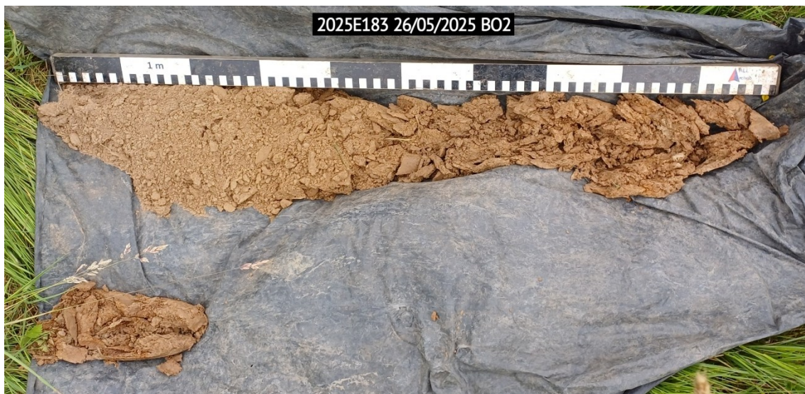
Figuur 23: Boorprofiel 2 met de bovenzijde linksboven en de onderzijde rechtsonder
