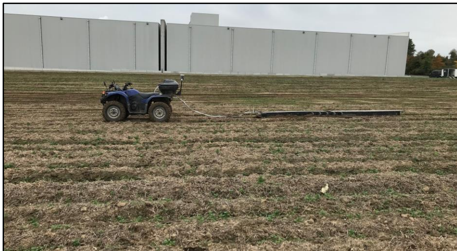
Figuur 4: Mobiele sensorconfiguratie met de EMI sensor in de slede en RTK-GPS.
