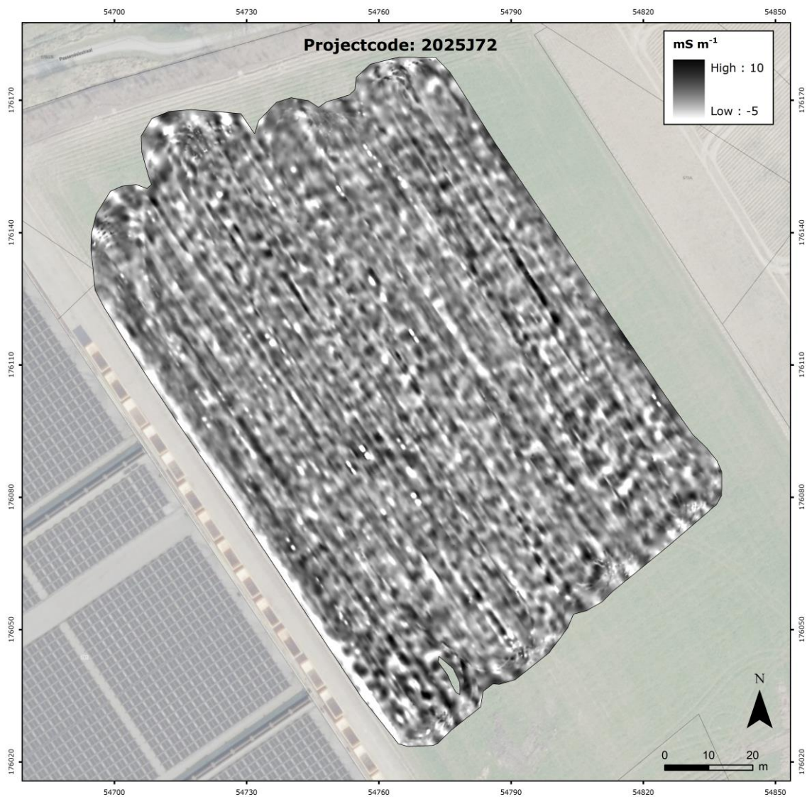
Figuur 11: 'High-pass' gefilterde EG opgemeten met de 2HCP spoelconfiguratie (dominante respons tussen 0 en 3.2 m diepte).
