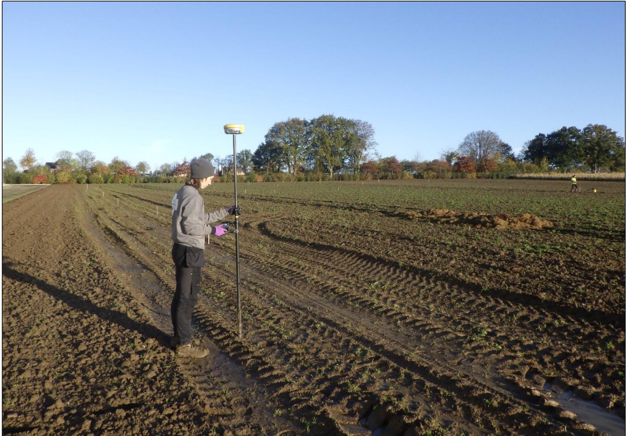
Figuur 4 Uitzetten van de anomalieën uit het geofysisch onderzoek, voorafgaand aan de start van het proefsleuvenonderzoek.
