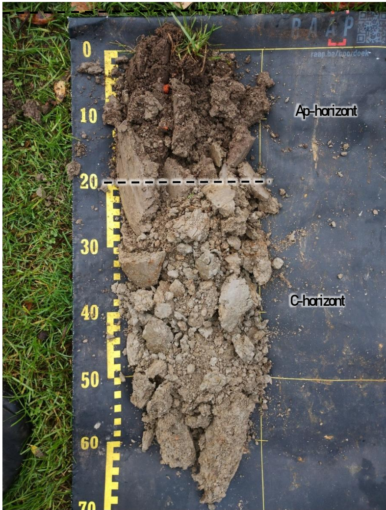
Figuur 33. Foto van boring 2 met aanduiding van de aardkundige eenheden.
