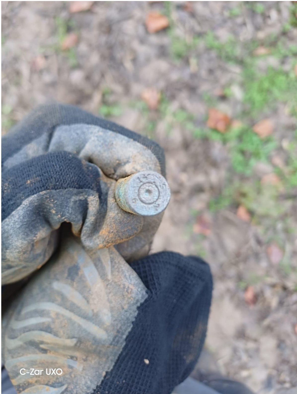
Figuur 2: Stempel onderaan leert ons meerdere zaken: de datum van productie (9/1914), de producent en het loodgehalte.
