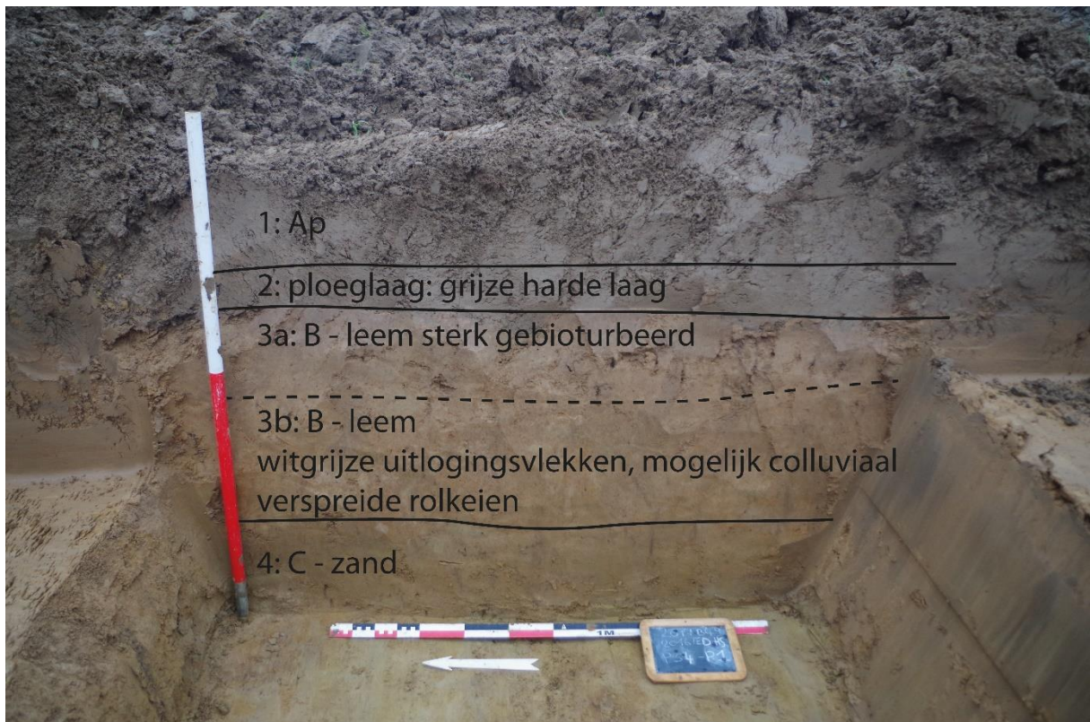
Figuur 23. Proefsleuf 4, profiel 1: bodemopbouw zuidelijke deel van het projectgebied, met mogelijk colluviale laag.
