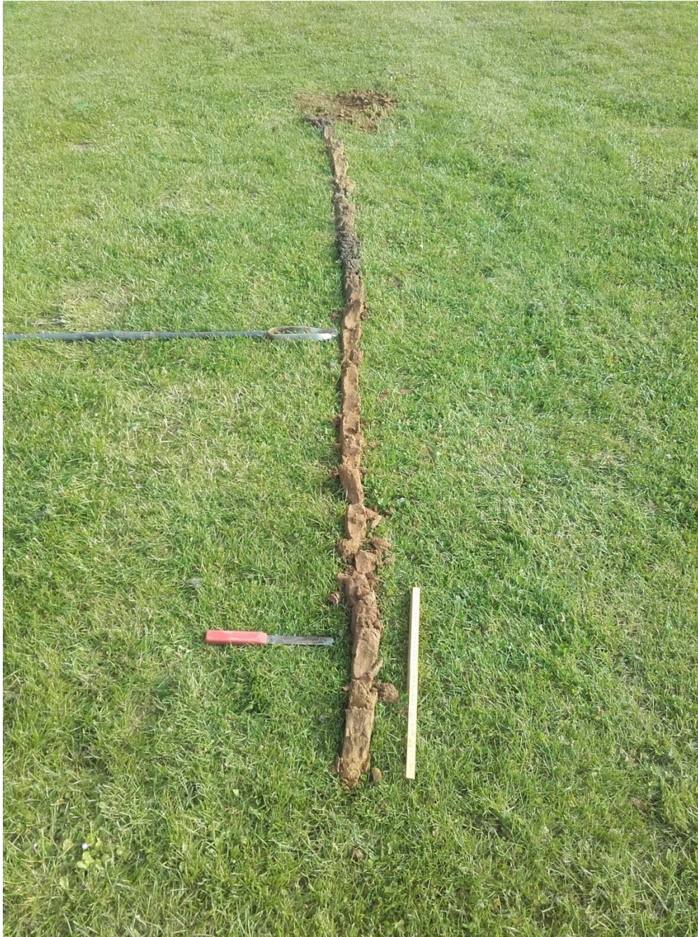
Figuur 10. Bodemprofiel in boring 1. De boor geeft de grens tussen het opgebrachte pakket en het colluvium aan; het boormes de grens tussen het colluvium en de C-horizont.
