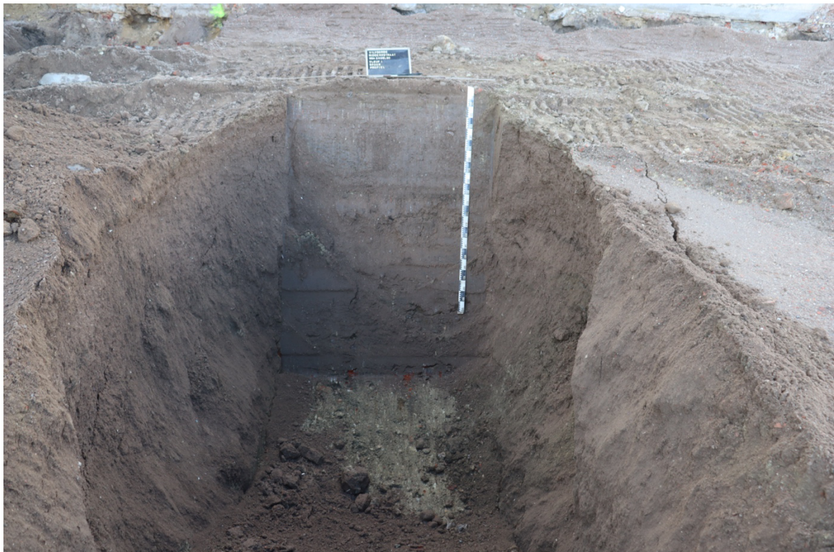
Fig. 2.6: Deel van proefsleuf 1 met zeer onstabiele wanden met op meer dan 2,5m diepte nog steeds geroerde grond.
