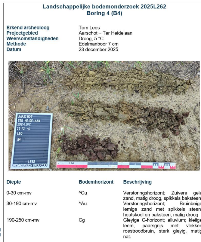
Figuur 11: Referentiebodemprefiel 4 met een C-horizont vanaf 190 cm-mv.
