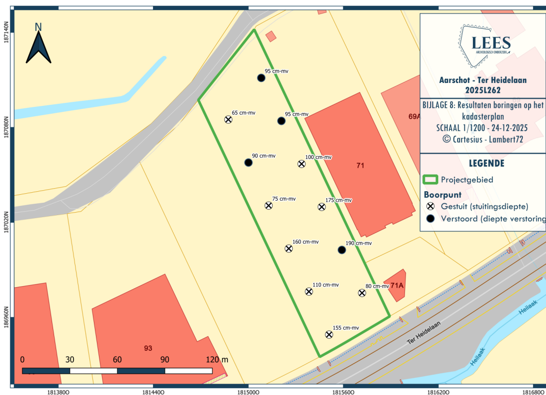
Figuur 8: De verstoringsdiepte of stuitingsdiepte van de landschappelijke boringen weergegeven op de het kadasterplan (© AGIV).
