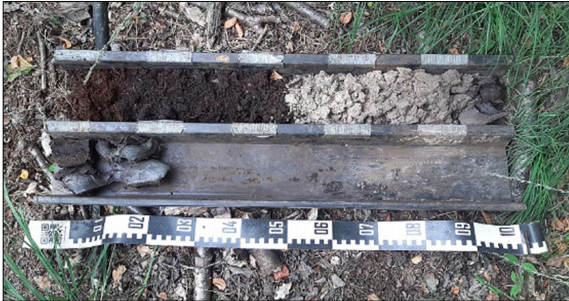
Figuur 13 : Boring LBO 1, van 0 (linksboven) naar 120 cm (linksonder) beneden het maaiveld
