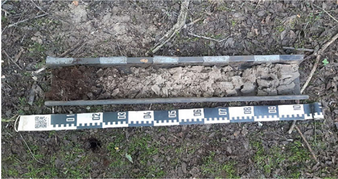
Figuur 15 : Boring LBO 6, van 0 (links) naar 100 cm (rechts) beneden het maaiveld
