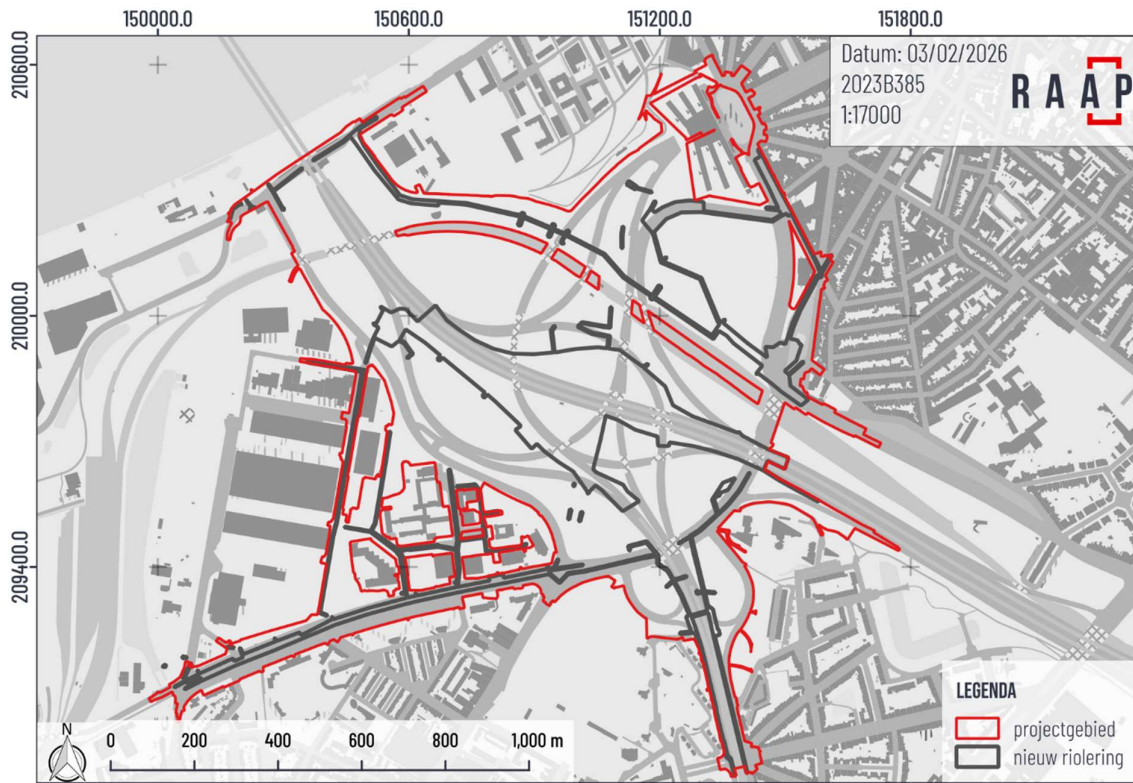
Figuur 23. Weergave van de locaties waar nieuwe rioleringen worden aangelegd (Bron: opdrachtgever, 2026).
