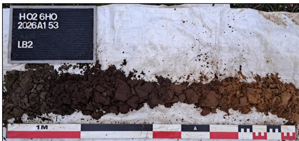
Afb. 28: LB2 met een T-Ap2-B-C-profiel (Bron: ARON bv, dd. 13/01/2026, 2026A153).
