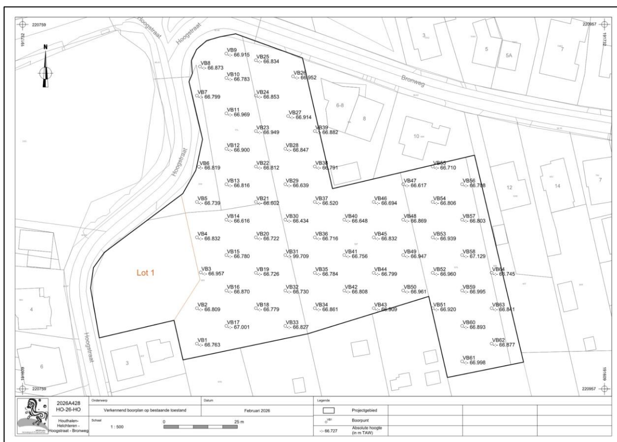
Afb. 34: Boorplan voor megaboringen op bestaande toestand (Bron: ARON Bv, digitaal plan, 2026A428).
