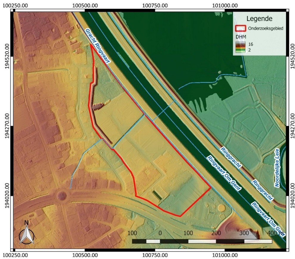
Figuur 8: Digitaal Hoogtemodel Vlaanderen II, DTM 1 m en Multidirectional hillshade DHM Vlaanderen I, 25 cm, met aanduiding van het onderzoeksgebied
