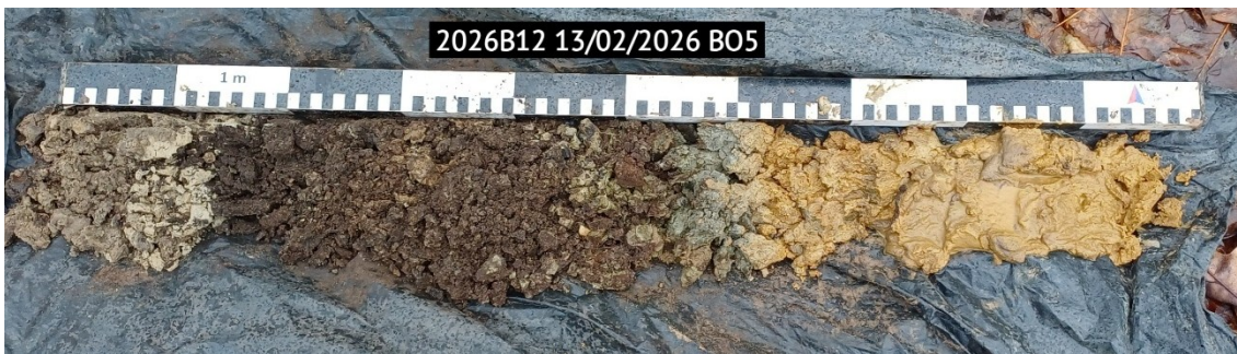
Figuur 12: Boorprofiel 5 met de bovenzijde links en de onderzijde rechts
