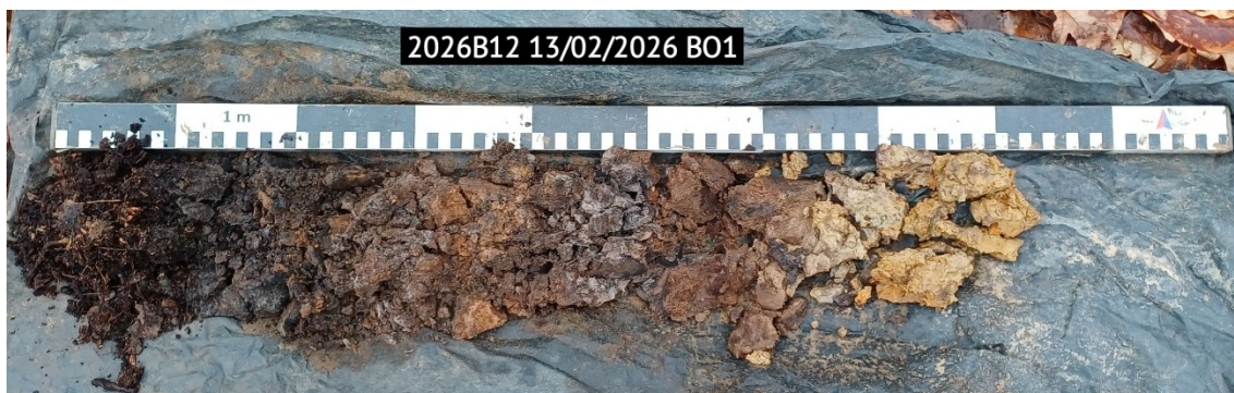
Figuur 9: Boorprofiel 1 met de bovenzijde links en de onderzijde rechts
