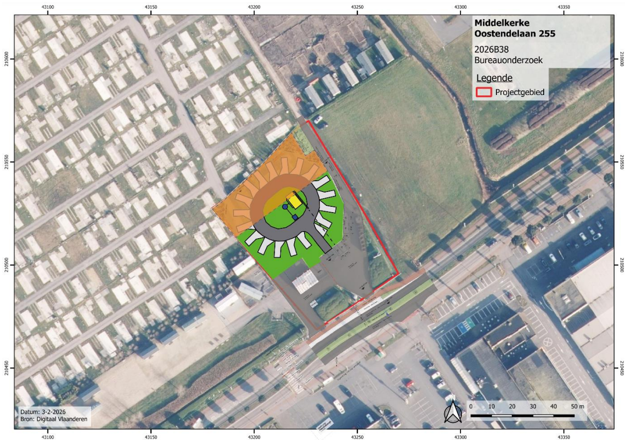
Figuur 1 Vereenvoudigde weergave van de geplande werken geprojecteerd op de GRB-basiskaart. Legende: geel: sanitair gebouw (-30cm); grijs: asfalt weg/parking (-30cm); wit: standplaats (-30cm); blauw: putten en wadi (-2m en -0,8m), zwarte lijn: riolering (-70cm), groen: groenzone (-15cm), oranje: ophoging +-44cm. (bron: geopunt).
