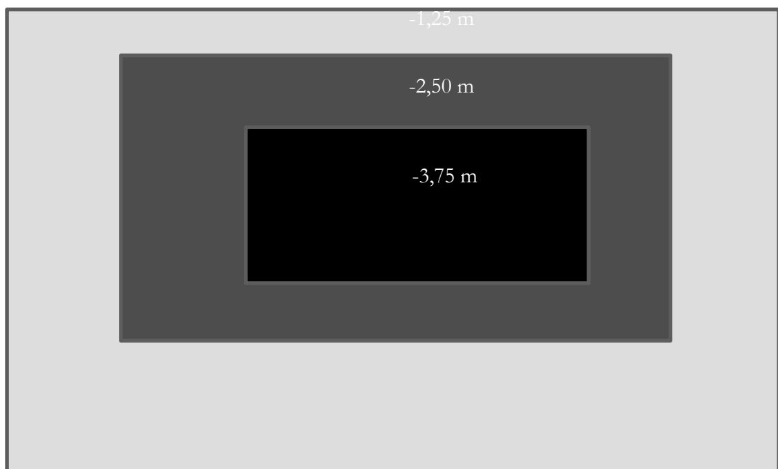
Afbeelding 2: Proefput met getrapte uitvoering veiligtechnisch per 1,25 m met schuine wanden.
