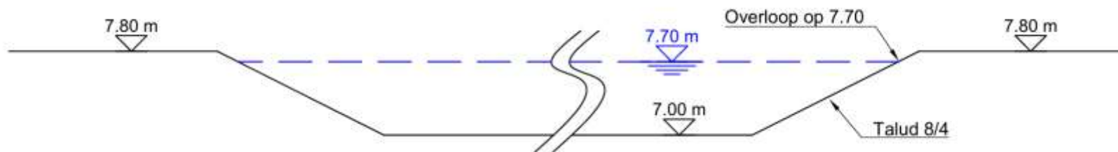
Figuur 3: Doorsnede van de toekomstige inplanting van de wadi's 6
