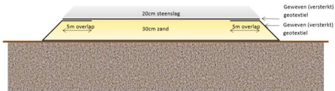
Figuur 5: schematische voorstelling van het principe van de ophoging van het terrein en de manier waarop de in situ-bewaring zal gegarandeerd worden.
