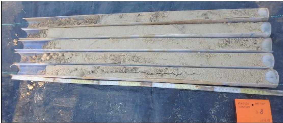
Figuur 20: Foto van boring 8 van 0 (bovenaan links) tot 500 cm (onderaan rechts) beneden maaiveld.
