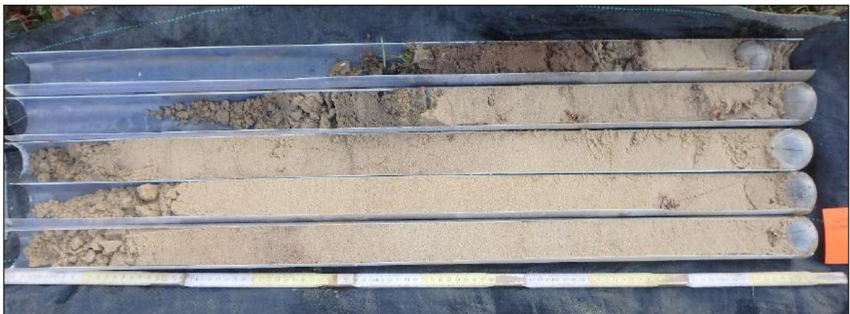
Figuur 25: Foto van boring 3 van 0 (bovenaan links) tot 500 cm (onderaan rechts) beneden maaiveld.
