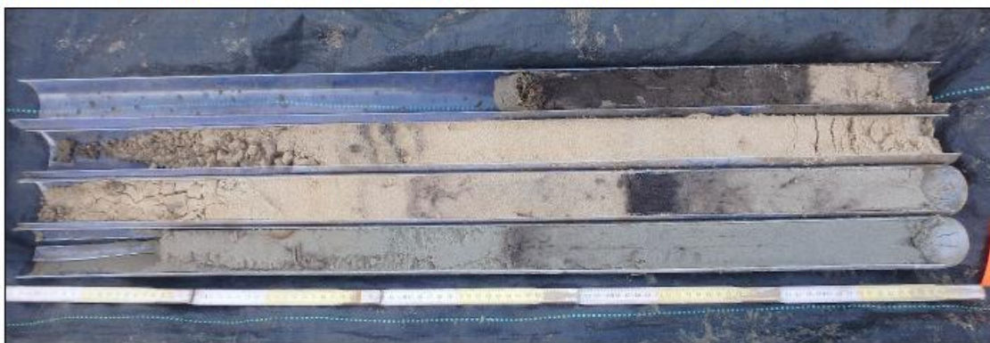
Figuur 22: Foto van boring 1 van 0 (bovenaan links) tot 400 cm (onderaan rechts) beneden maaiveld.
