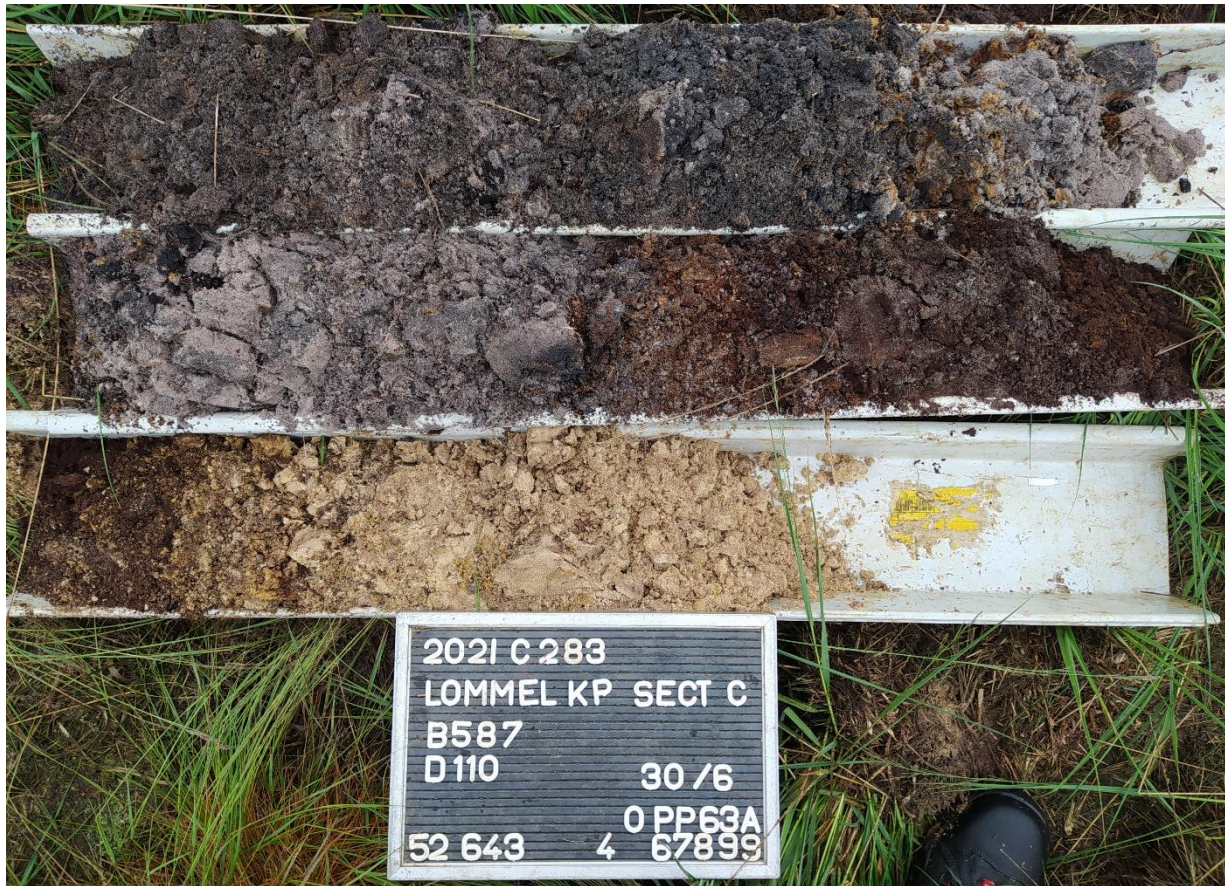
Figuur 6 Extra boring 587 tot einddiepte 110 cm.
