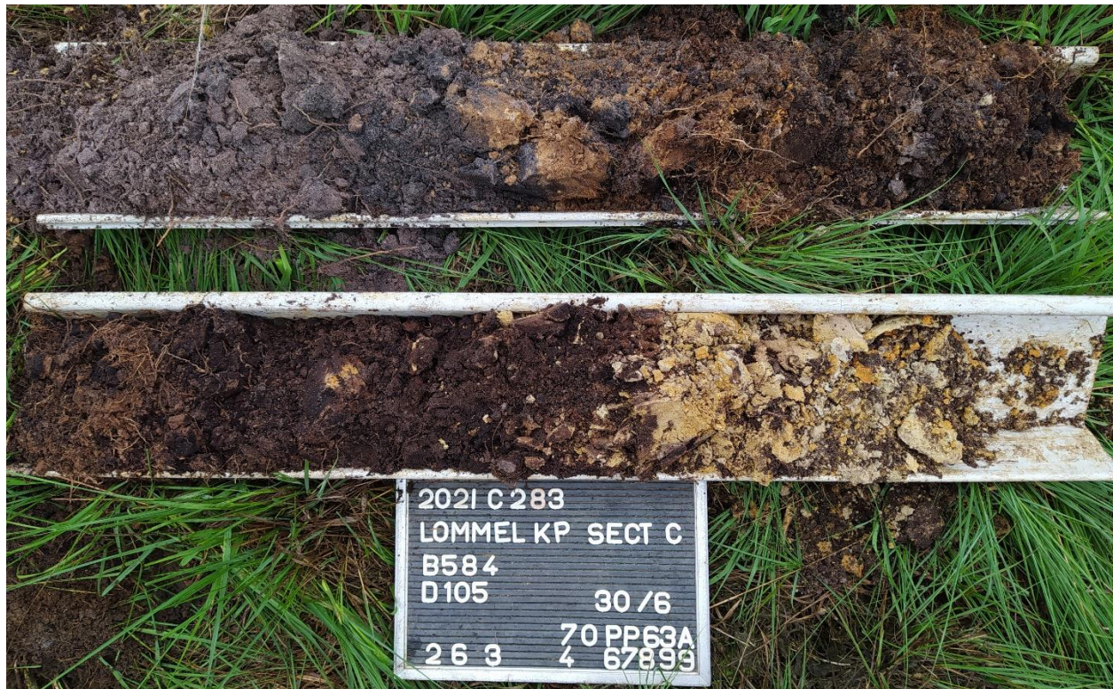
Figuur 4 Extra boring 584 tot einddiepte 105 cm.
