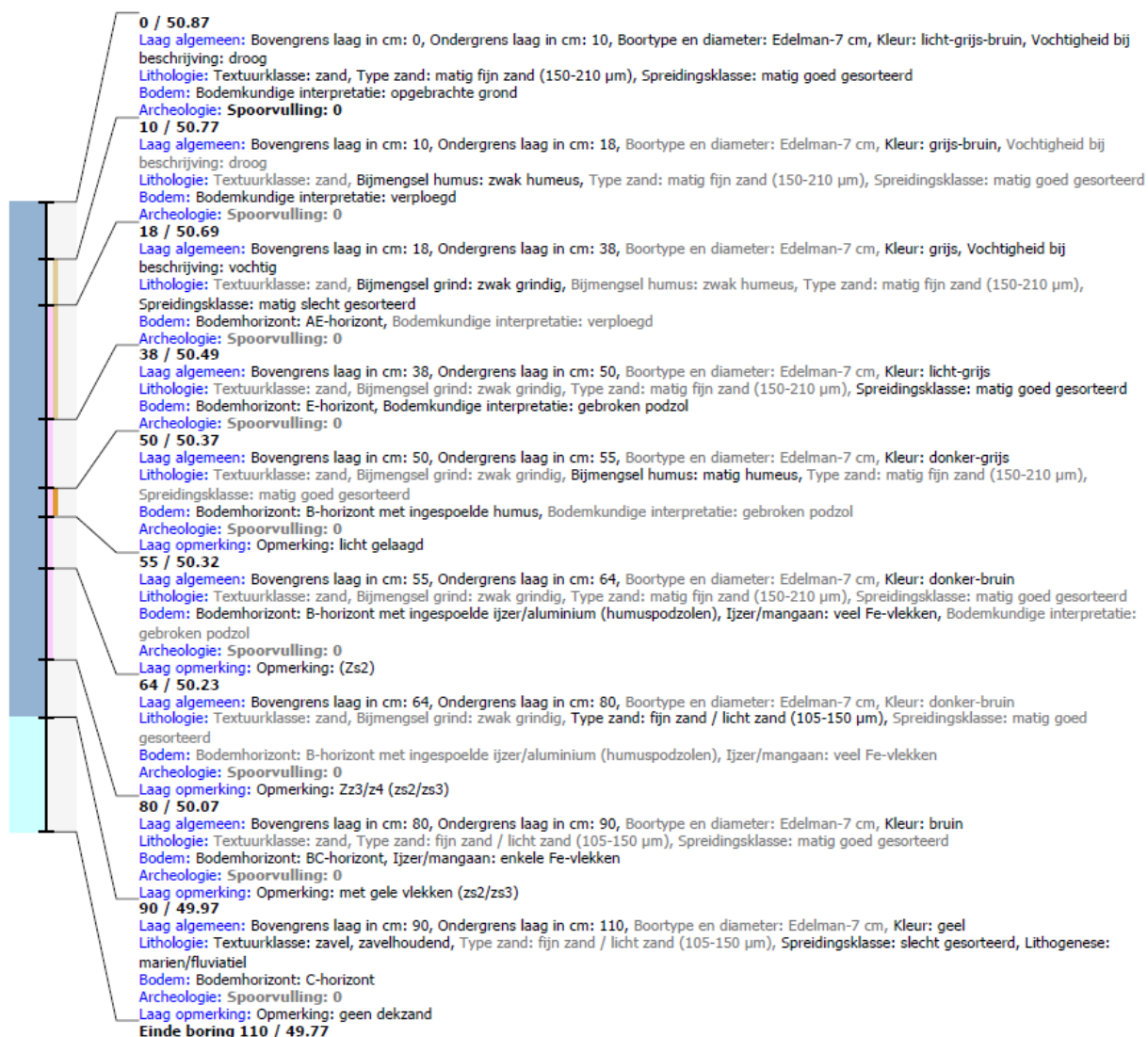
Figuur 5 LBO boring N004 foto en beschrijving
