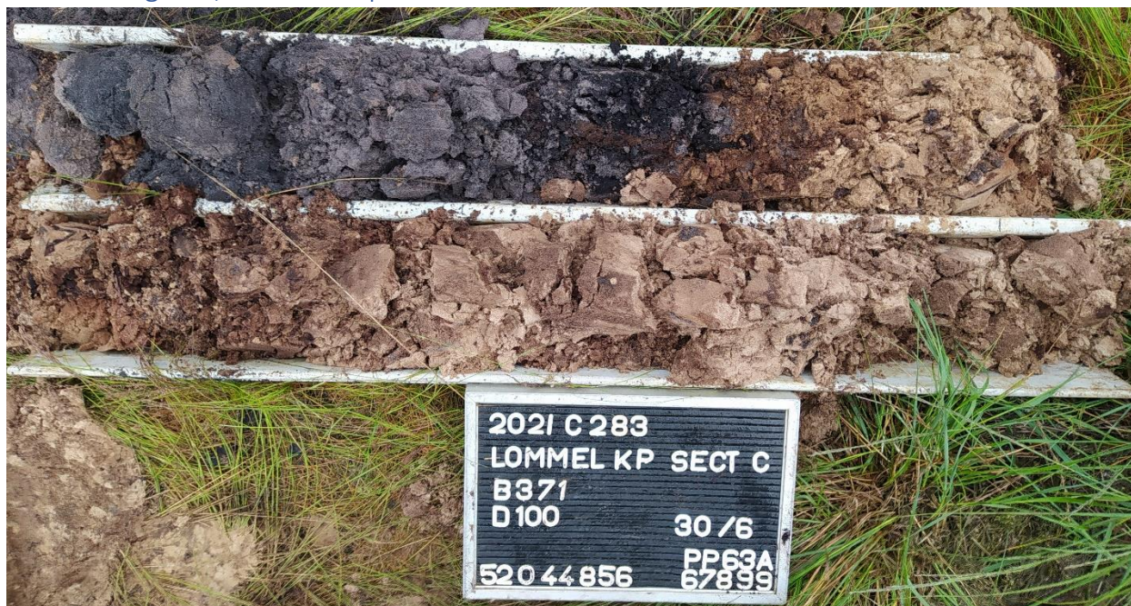
Figuur 12 Extra boring 371 tot einddiepte 100 cm.
