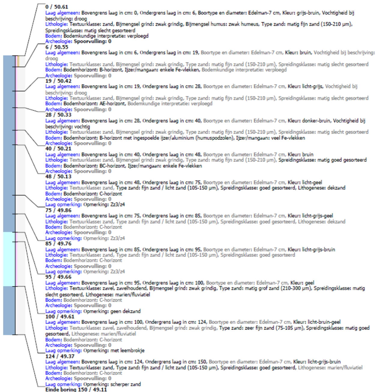
Figuur 7 LBO boring N005 foto en beschrijving
