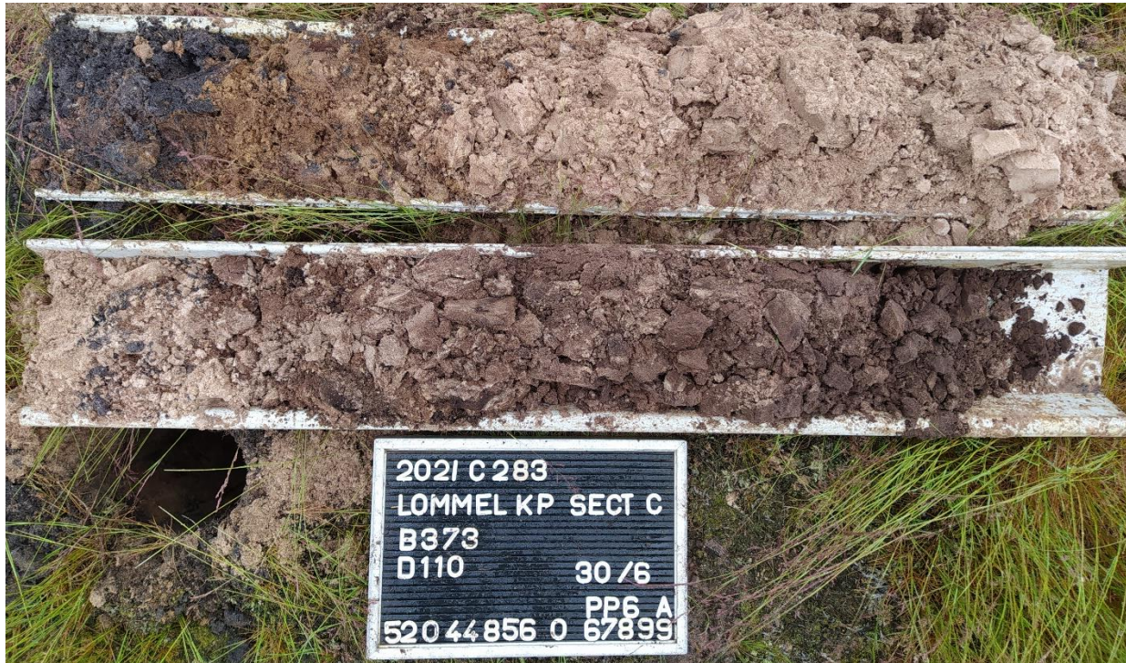
Figuur 14 Extra boring 373 tot einddiepte 110 cm.
