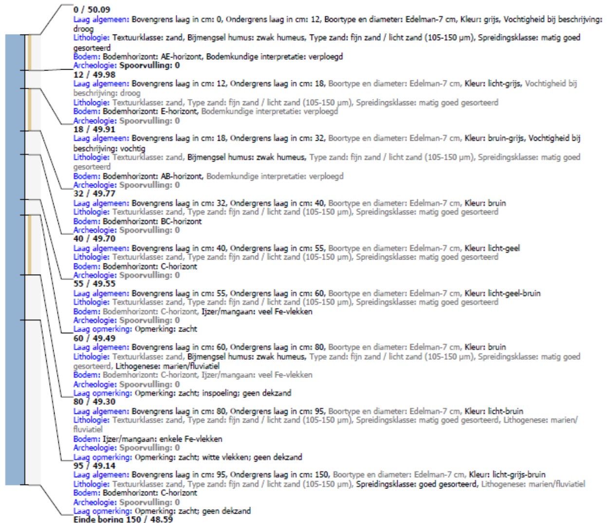
Figuur 9 LBO boring N031 foto en beschrijving.
