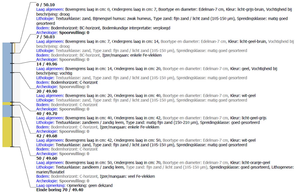
Figuur 3 LBO boring N028 foto en beschrijving
