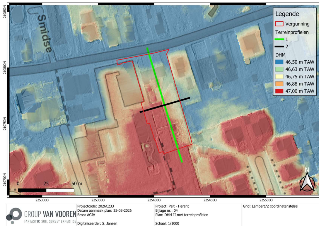
Fig. 1.9: Gedetailleerd digitaal hoogtemodel (DHM II) met situering van het projectgebied met terreinprofiel 1 (N-Z) en 2 (W-O) (@ AGIV).
