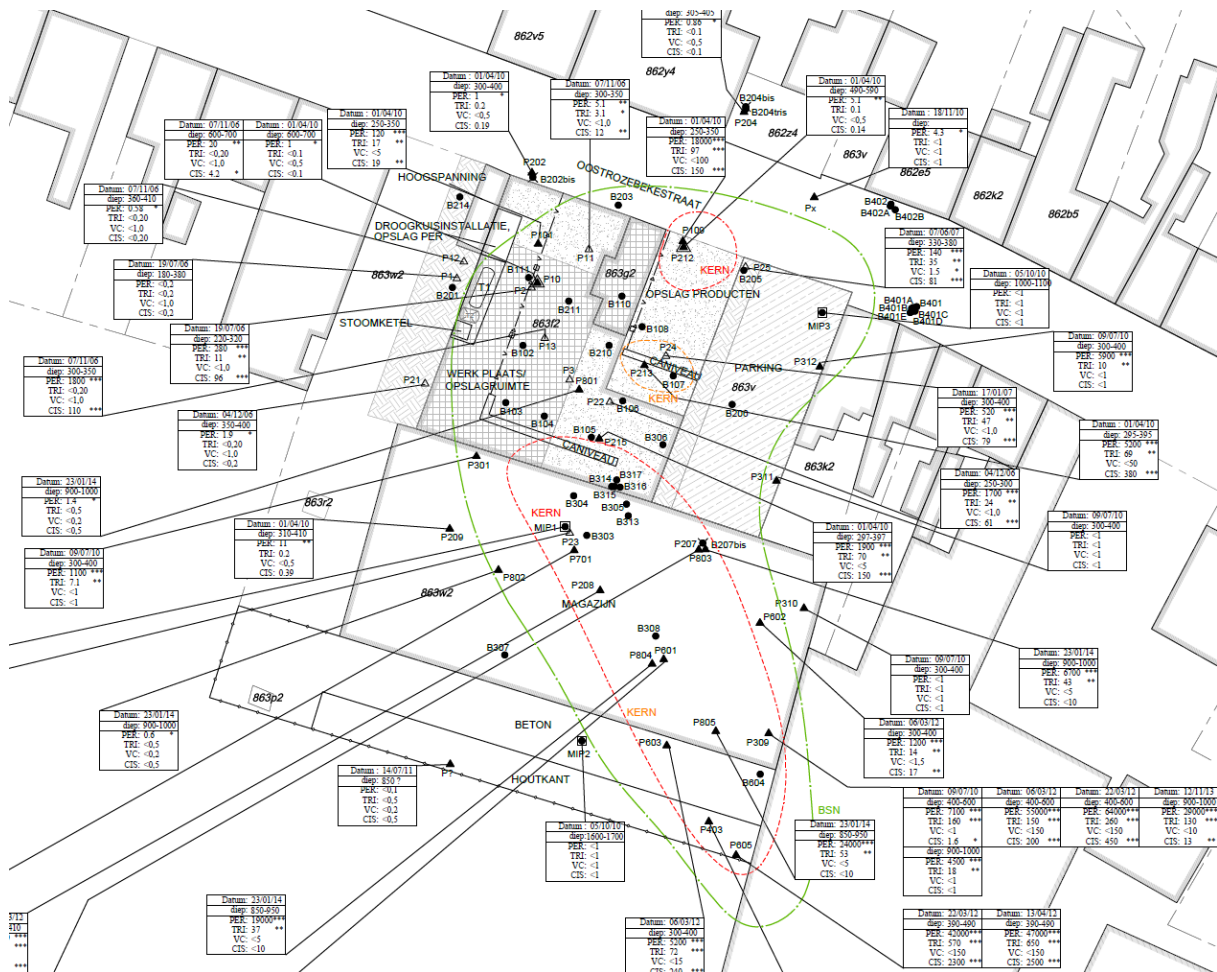
Figuur 26: Plan met uitgevoerde boringen in het plangebied uit het sonderingsrapport (aangebracht door de initiatiefnemer)
