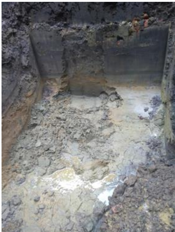
Figuur 42: Grondwater in proefput 1. (links: meteen na aanleg, rechts: enkele uren later)
