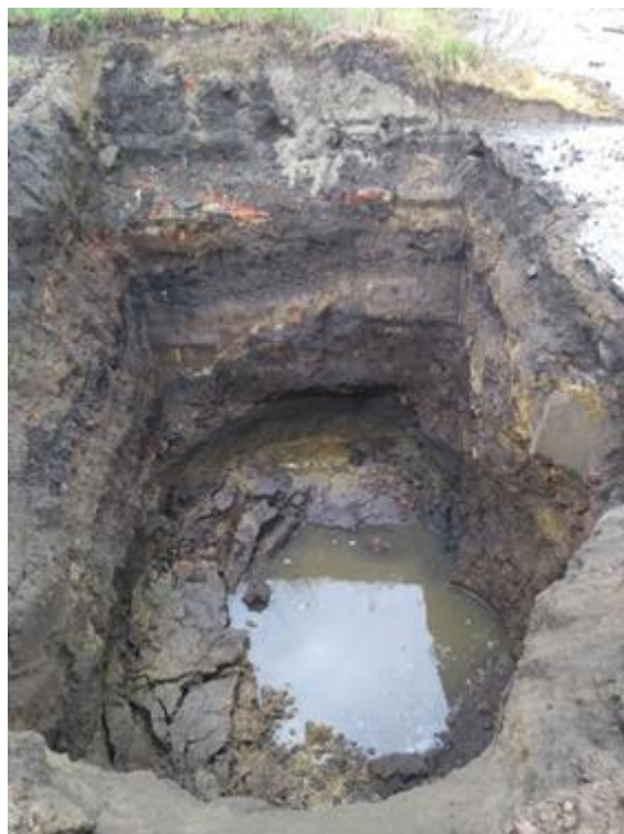
Figuur 42: Grondwater in proefput 1. (links: meteen na aanleg, rechts: enkele uren later)
