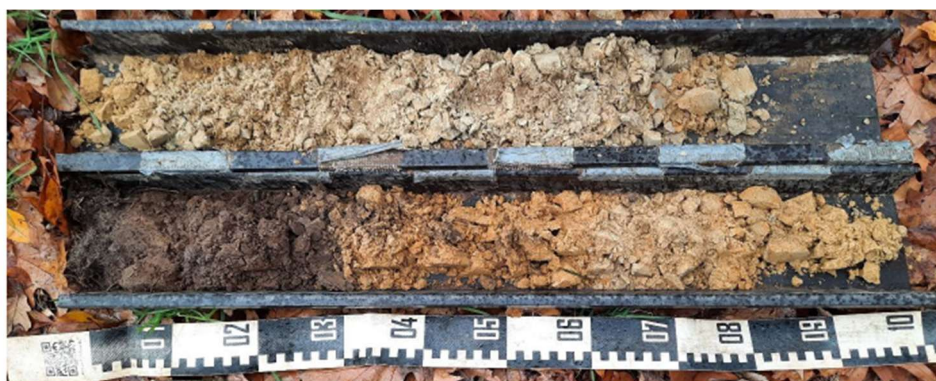
Fig. 1.67: Boring 15, van 0 (linksonder) naar 180 cm (rechtsboven) beneden het maaiveld (© Steenhoudt M. 2026, Figuur 14)
