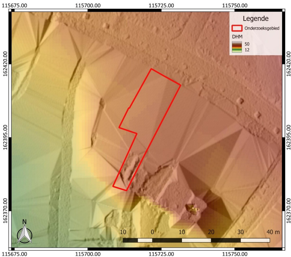
Figuur 9: Digitaal Hoogtemodel Vlaanderen II, DTM 1 m en Multidirectional hillshade DHM Vlaanderen I, 25 cm, met aanduiding van het onderzoeksgebied
