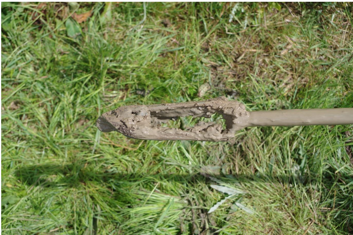
Foto 17. Zicht op een net uitgedraaide edelman-boorkop. De sterke uitspoeling bemoeilijkte het opstellen van een correct boorprofiel.
