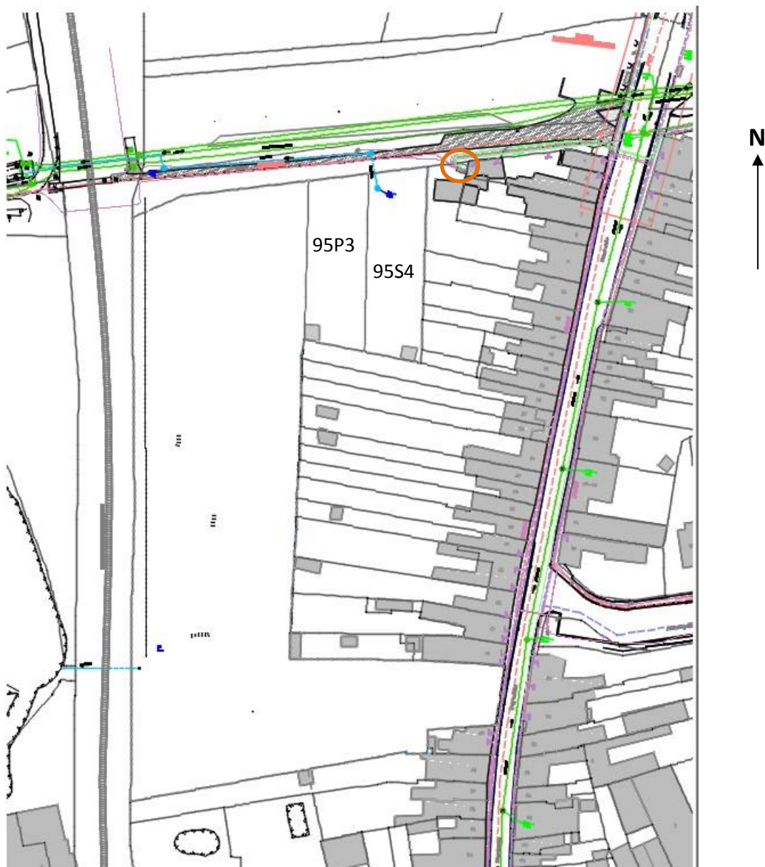
Figuur 3: Grondplan bestaande toestand met aanduiding van de bestaande weg en fietspad in het noorden en de diverse bestaande rioleringen en nutsvoorzieningen, alsook de elektriciteitscabine (oranje omcirkeld). (Bron: Bureau Cnockaert n.v.)
