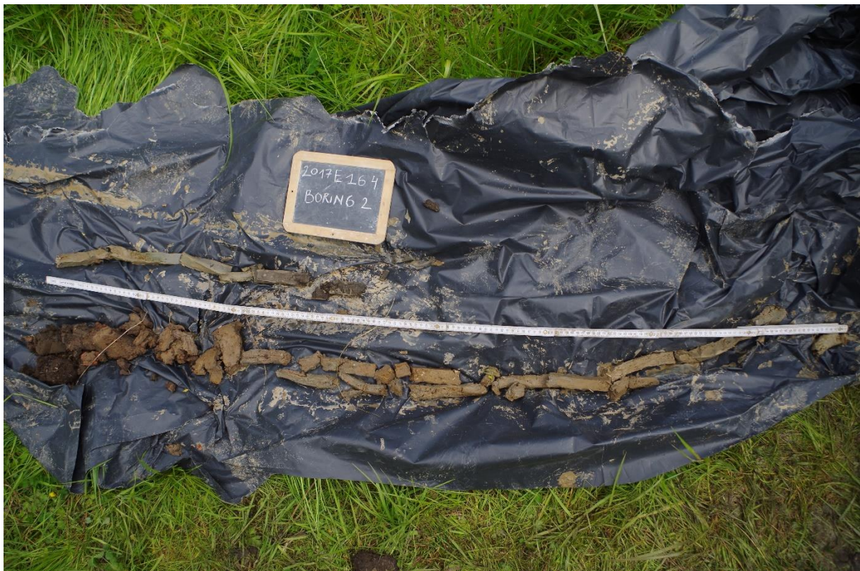
Foto 19. Boorprofiel van boring 2. Zoals vermeld was het door de sterke uitspoeling van de boorkoppen niet mogelijk om een correct boorprofiel op te stellen. Het begin van het profiel ligt links onderaan en loopt dan naar rechts, om verder te lopen linksboven; het einde ligt rechtsboven.
