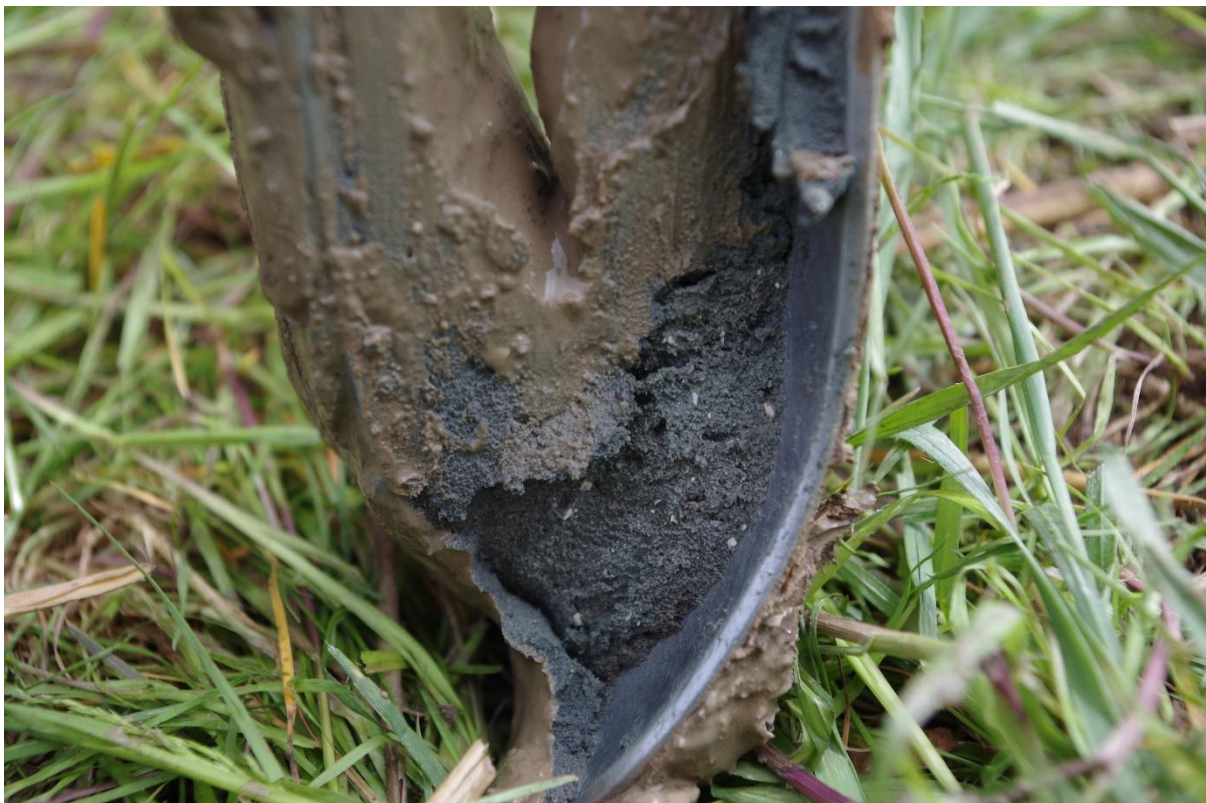
Foto 20. Detailopname van laag 5 in boring 1 bij het opboren.
