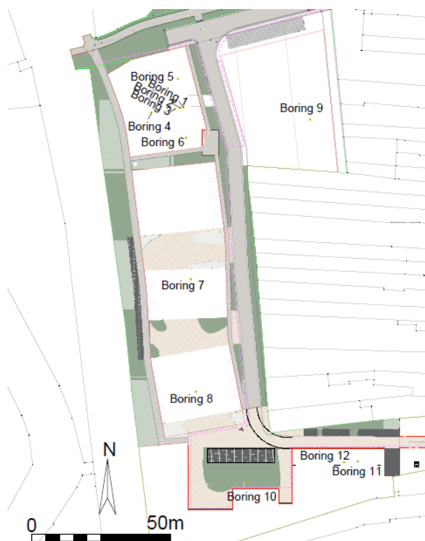
Figuur 20: Plan met aanduiding van de uitgevoerde controleboringen. (Bron: SOLVA op basis van de ontwerpplannen)
