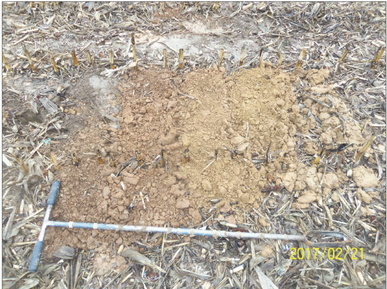
Fig. 3.8: Boring, met staalnamepotjes, uitgevoerd door de medewerkers van de bodemkundige Dienst van België.
