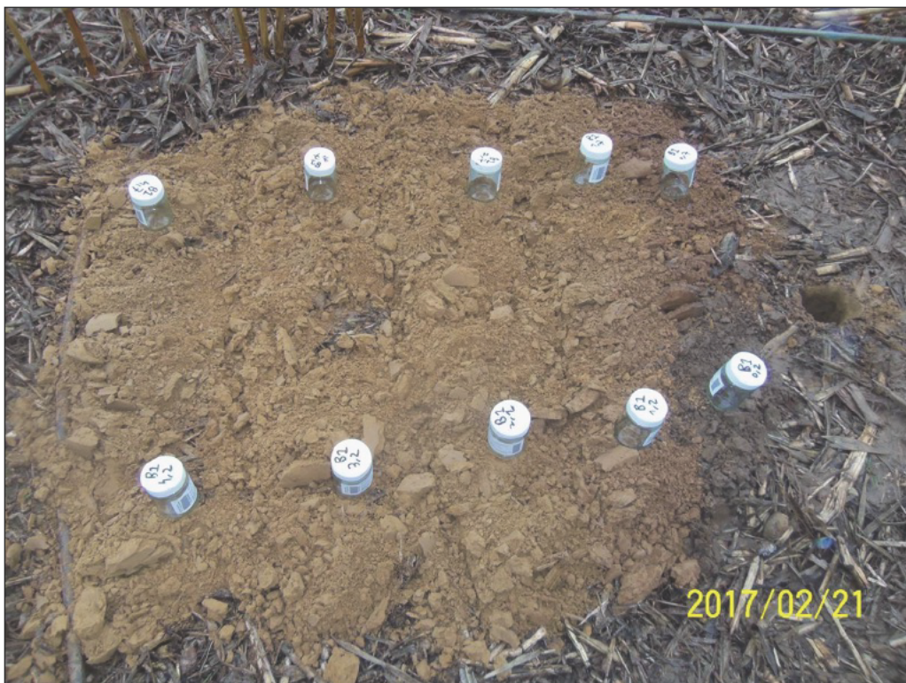
Fig. 3.7: Boring, met staalnamepotjes, uitgevoerd door de medewerkers van de bodemkundige Dienst van België.
