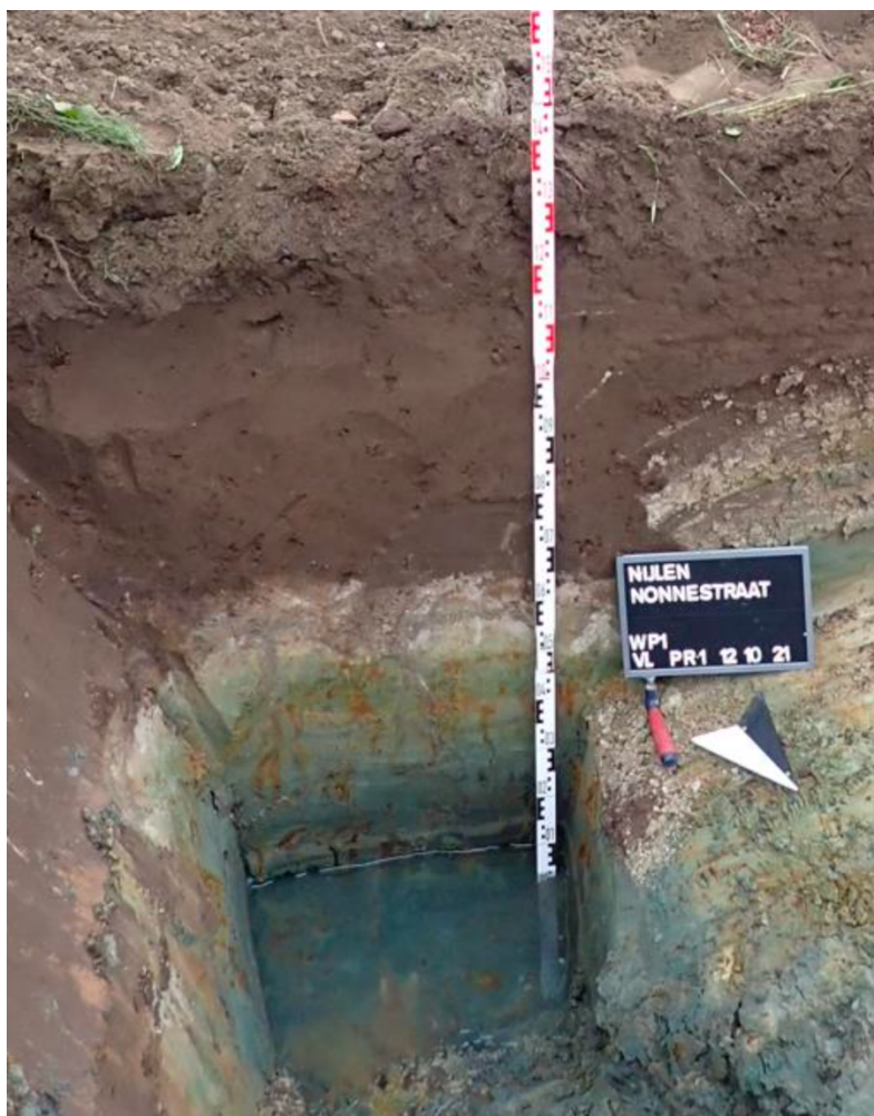
Fig. 1.5: Referentieprofiel A/C-bodemopbouw met daaronder fluviatiele afzettingen.
