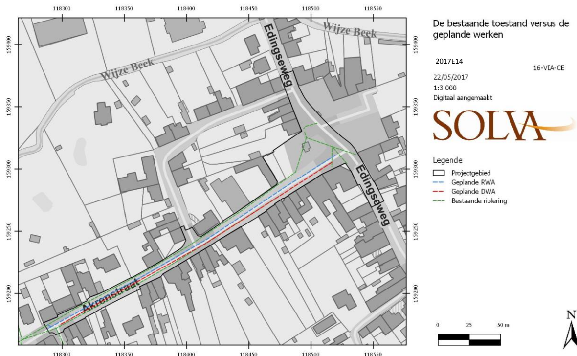
Figuur 19. Weergave van de bestaande toestand van de rioleringen versus de geplande toestand (eigen bewerking, naar plannen van Studiebureau Arcadis).
