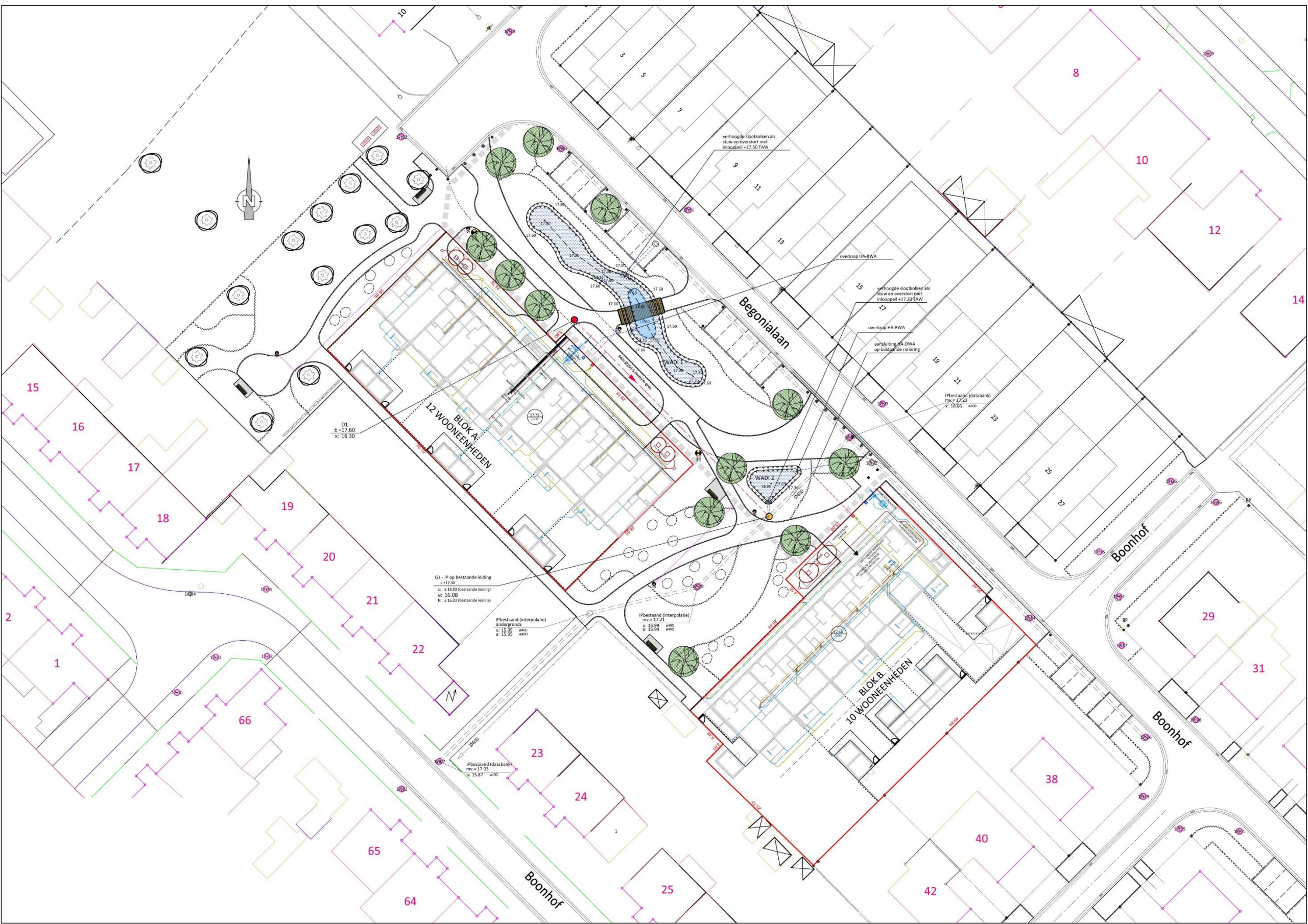
Figuur 9: Ontwerpplan riolering (Architectenbureau FCS)
