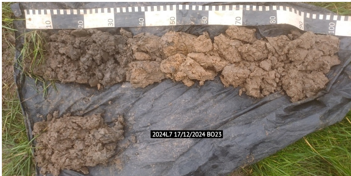
Figuur 17: Boorprofiel 23 met de bovenzijde linksboven en de onderzijde rechtsonder
