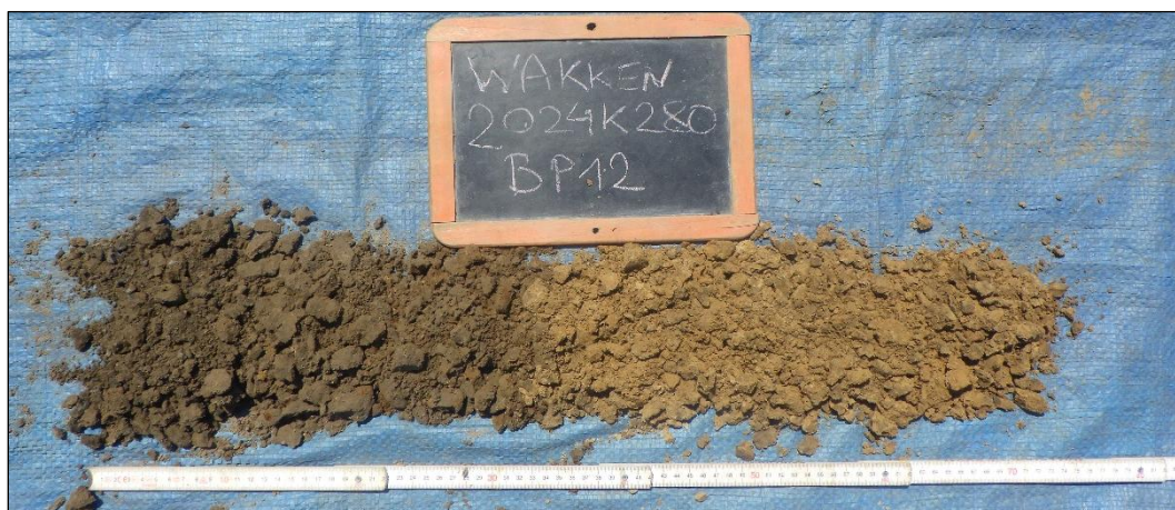
Figuur 16 Zicht op boorsequentie 12 met Ap-C profiel.
