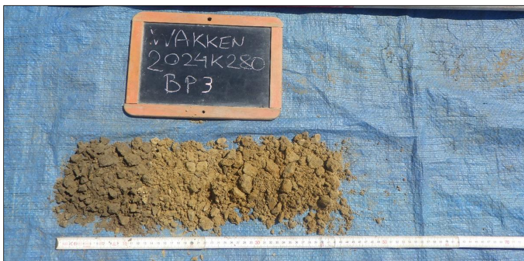
Figuur 7 Zicht op boorsequentie 3 met Ap-C profiel.
