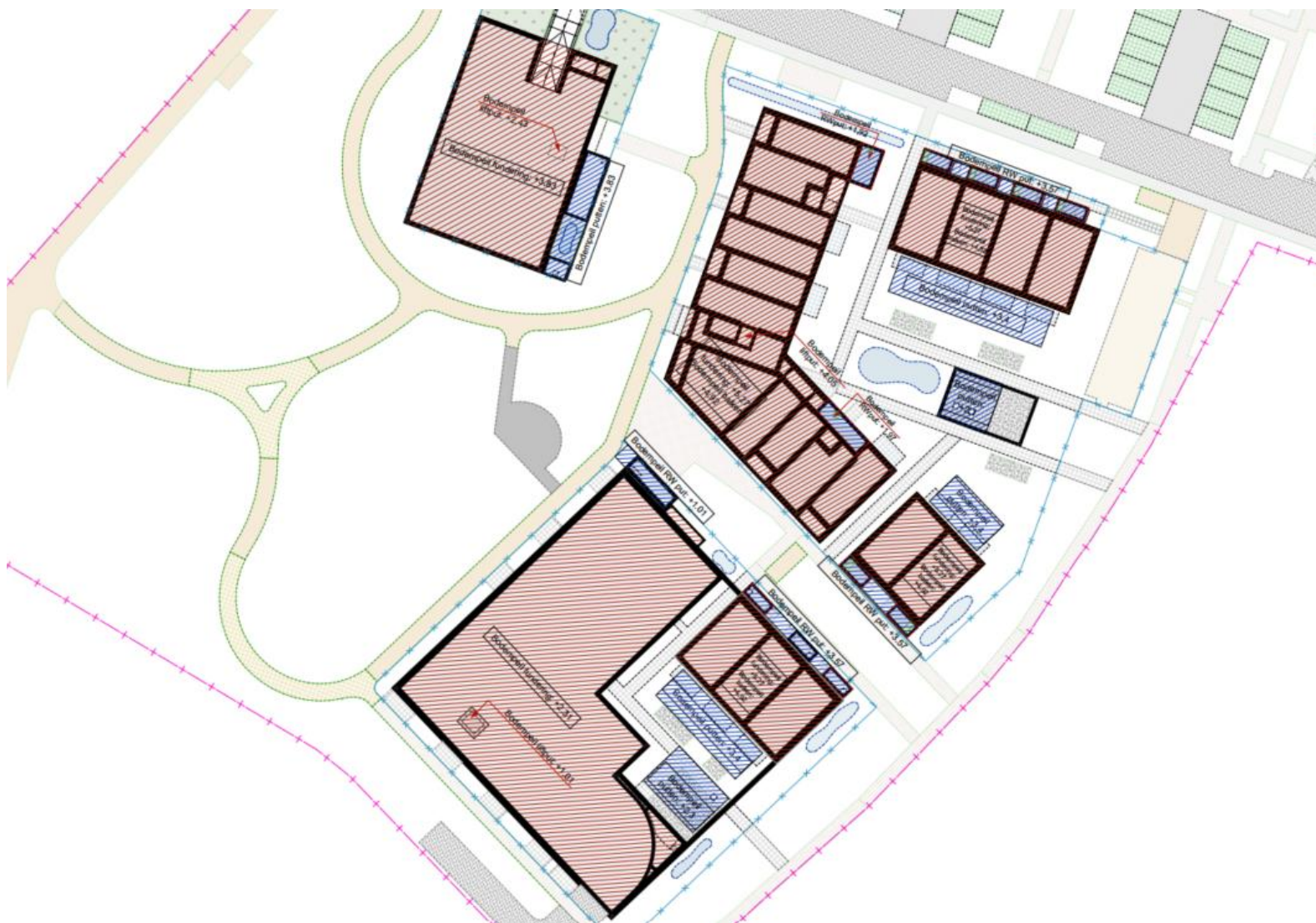
Figuur 5: Inplantingsplan met bodempelen van de funderingen en putten.
