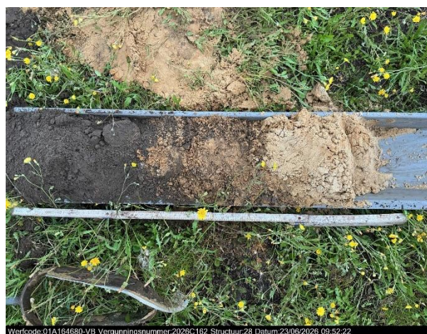
Figuur 13: Boring 28 en 37. Voorbeelden van de bodemopbouw onder het voetbalveld.
