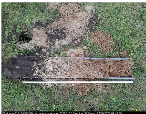
Figuur 13: Boring 28 en 37. Voorbeelden van de bodemopbouw onder het voetbalveld.
