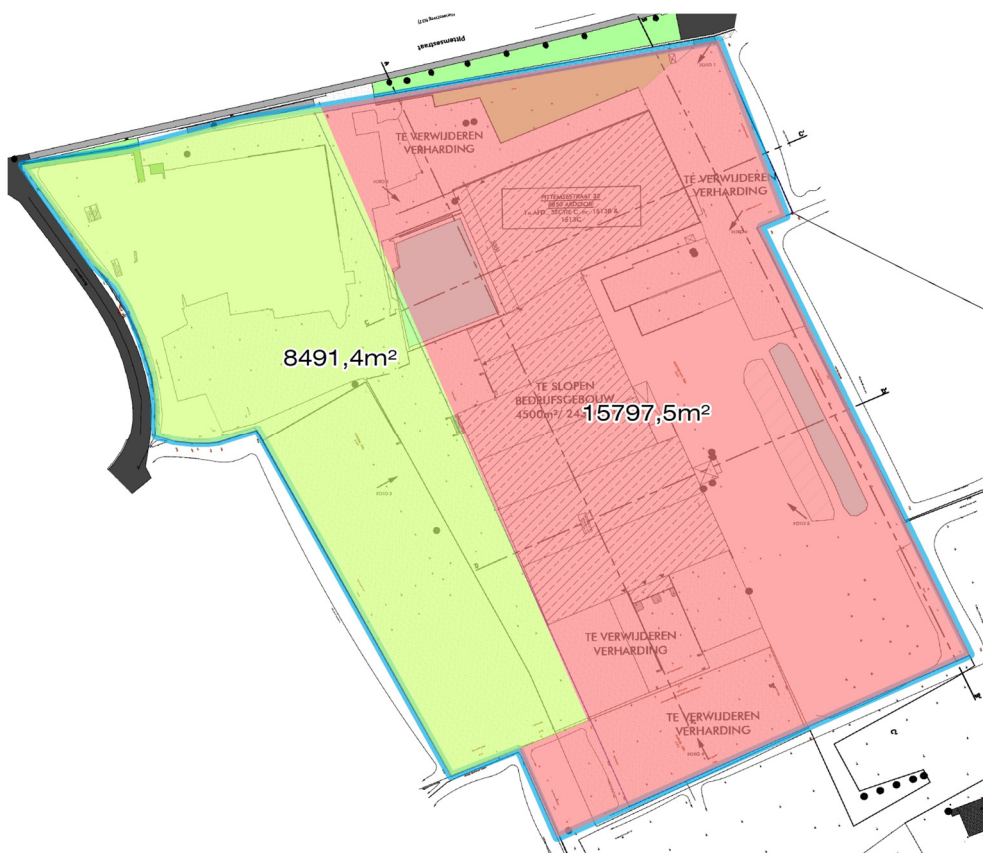
Figuur 3. Impact op de bodem bij de sloop van het oostelijke deel van het onderzoeksgebied, aanvraag 2026.
