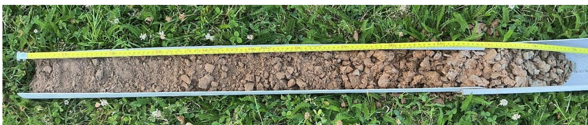
Figuur 21: Boring B3 met een Ap1 – Ap2 – C opbouw en een diepte van 1,20 m.
