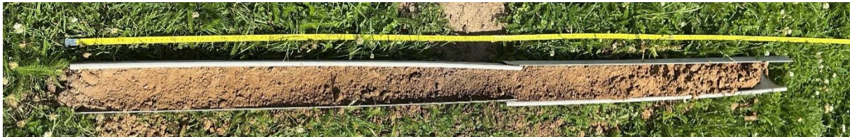
Figuur 20: Boring B2 met een Ap1 – Ap2 – AC – C opbouw en een diepte van 1,90 m.
