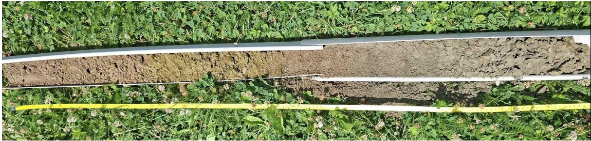
Figuur 19: Boring B1 met een ^Ap - ^C – Ap – C opbouw en een diepte van 1,60 m.
